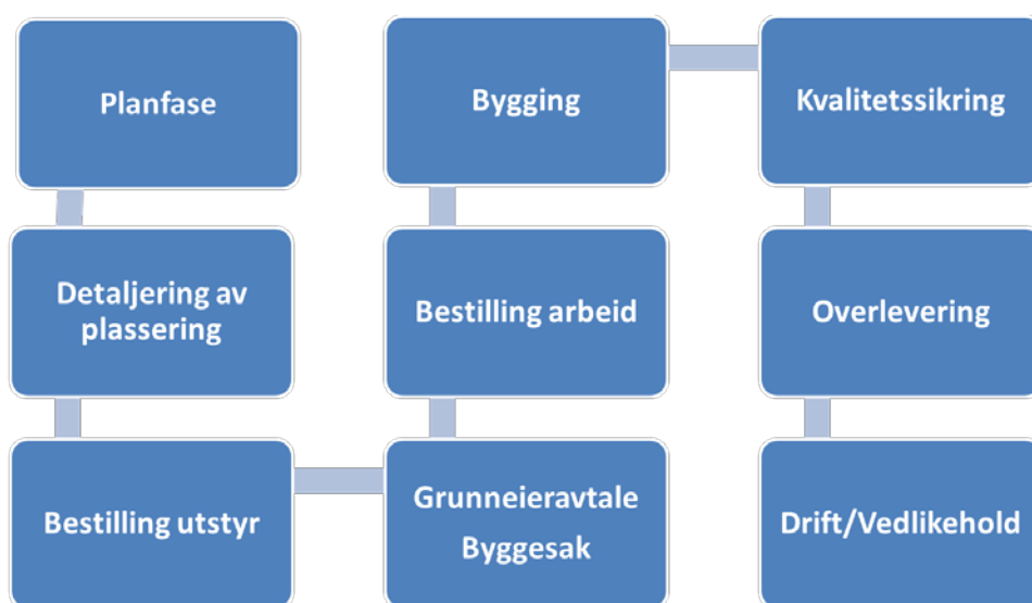
FIGUR 1-5 PROSESSEN VED PLANLEGGING OG BYGGING AV MÅLESTASJONENE
