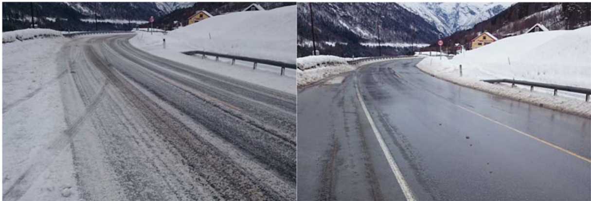
Figur 21. Til venstre: Ved Kyllingbru kl. 0910, 15Ev136 hp1 16740m rett før brøytebil passerte. Det ble også strødd salt. Til høyre: Ved Kyllingbru kl. 1030, vegen her er bar.
