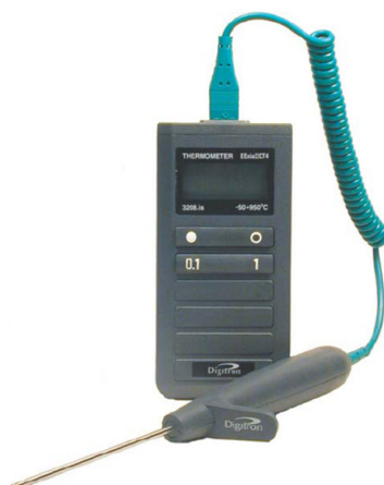
Figur 3.5 (49) Termometer benyttet ved gjennomføring av måleserier
