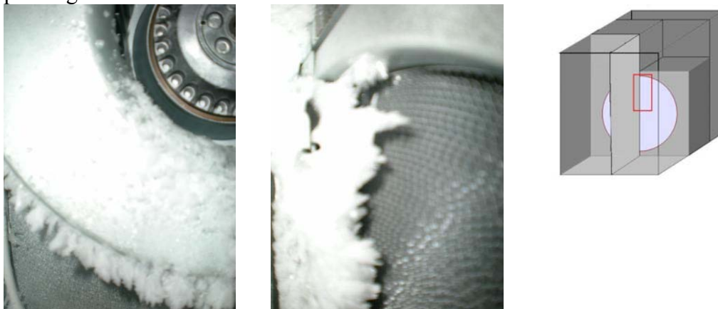
Figur 5-12 Is på vifte og foran veksler etter 37 timer.
