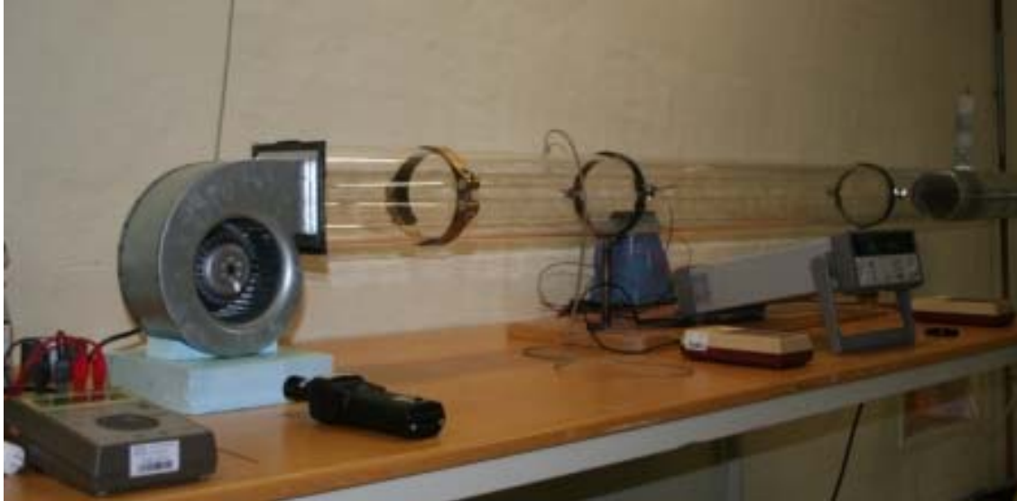
Figur 4-6 Målepunkter for turtall, statisk trykk og luftmengde.
