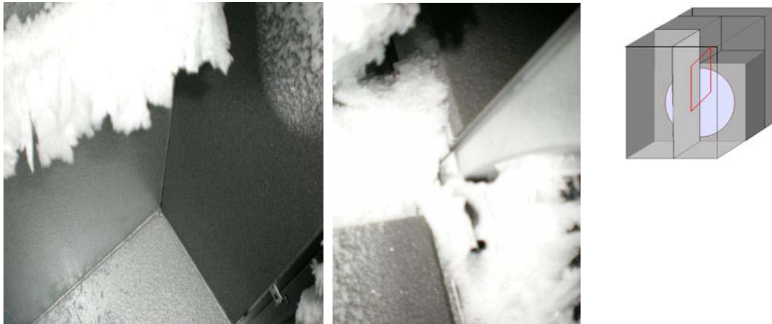
Figur 5-13 Is i aggregatet ved slutten av Defrost 3
