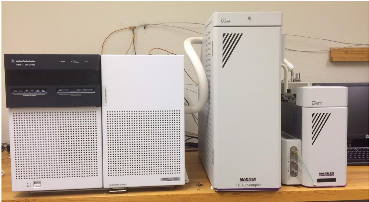
Figur 3.4.3: Analyseoppsett for kjemiske forbindelser med Agilent Technologies 5975T LTM GC_MSD system, Markes International Series 2 Ultra TD Autosampler og Markes International Series 2 Unity Thermal desorber.
