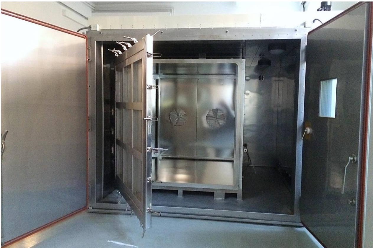
Figur 3.4.1.1: Vötsch Indusritechnik GmbH Emission Test Chamber VCE 8000/S ble benyttet til utførelse av emisjonsforsøkene.
