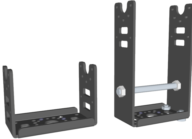
Figur 5.10: Til venstre er den originale braketten, mens til høyre er den modifiserte
