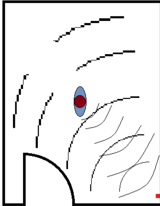
Figur 2: Prinsippskisse ultrasonisk sensor plassert i hjørnet av et rom.
