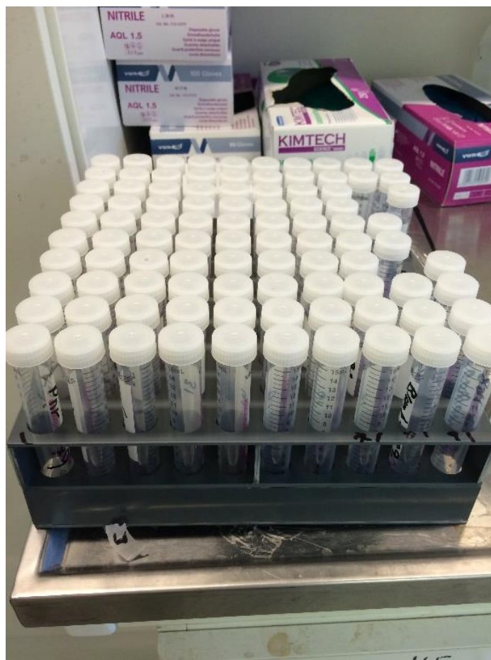
Figur 4.2.3: Klargjøring av prøver til ICP-MS-analyse (Foto: privat)
