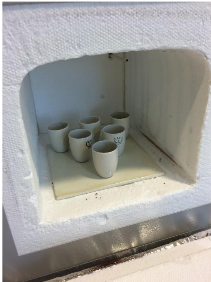
Figur 3.3.1: Prøver i digel satt til glødetap i glødeovn (Foto: privat)
