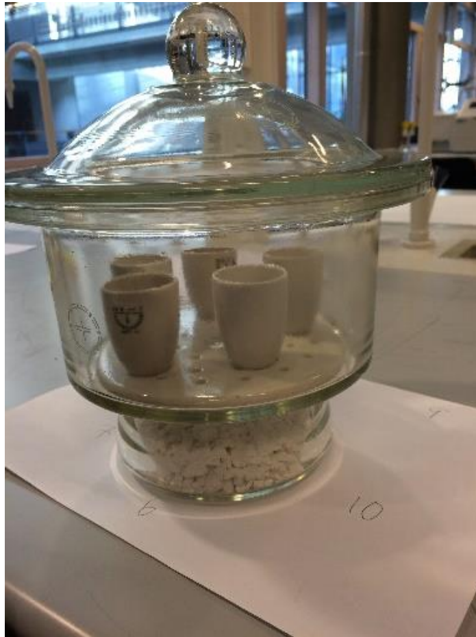
Figur 3.3.2: Prøver til glødetap oppbevart i eksikator (Foto: privat)
