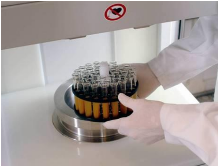
Figur 3.1.1: Illustrasjon av hvordan prøvene settes ned i loaden i UltraCLAVE (milestone, udatert)
