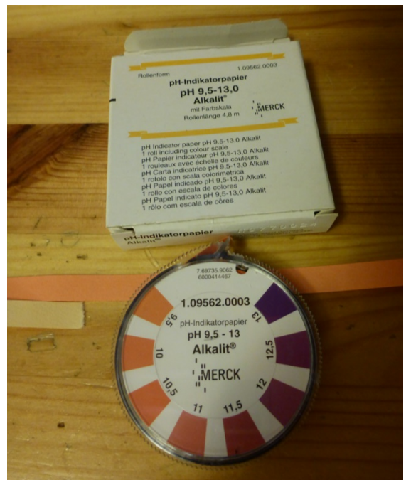
Foto 4 pH-papir for pH-måling mellom pH 9,5 og 13 med intervallar på 0,5
