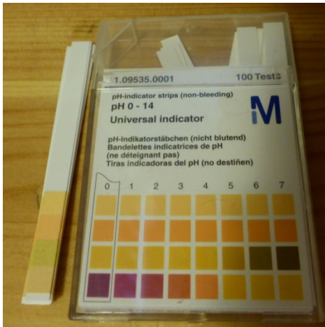
Foto 1 pH-strips for grovt-overslag av pH, med intervallar på 1.
