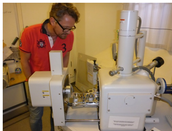
Foto 6.14: Prøven plassert i SEM-maskina. Klar for å skyvast inn i vakumkammeret.
