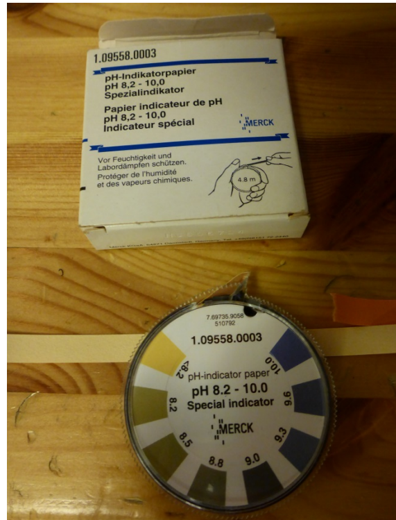
Foto 3 pH-papir for pH-måling mellom pH 8,2 og 10 med intervallar på 0,3
