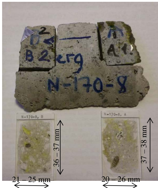
Foto 6.19 Foto av ferdig preparerte tynnslip og betongprøve frå Nesttuntunnelen, prøve N-170-8.
