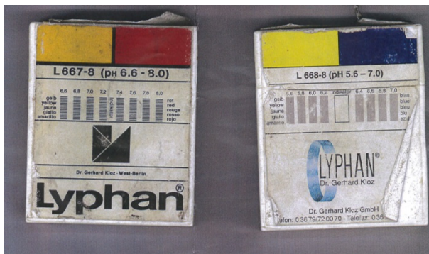
Foto 2 pH-papir for pH-måling mellom pH 6,6 og 8,0 med intervallar på 0,2
