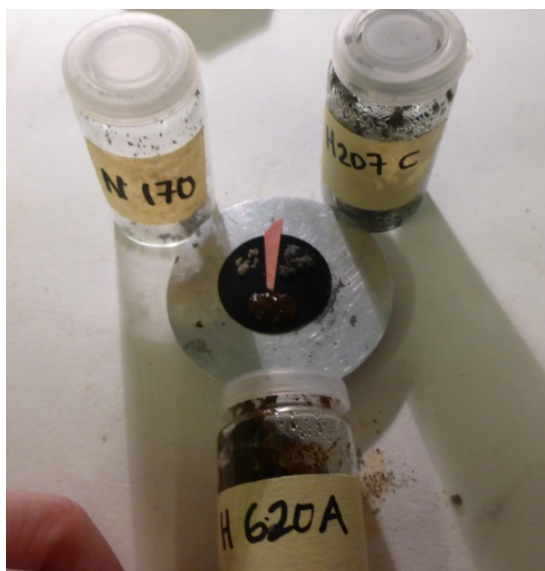
Foto 6.13: Prøvematerialet preparert for SEM. Det raude merket er for å kunne orientere prøven inne i maskina.
