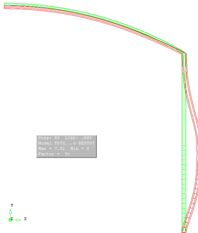
Figur 5.33: Deformasjon i lasttilfelle 55
