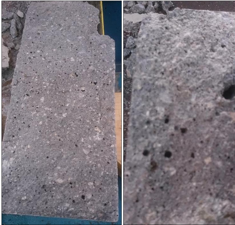
Figur 4.11: Bruddflaten til normalbetong med 0%fiberinnhold
