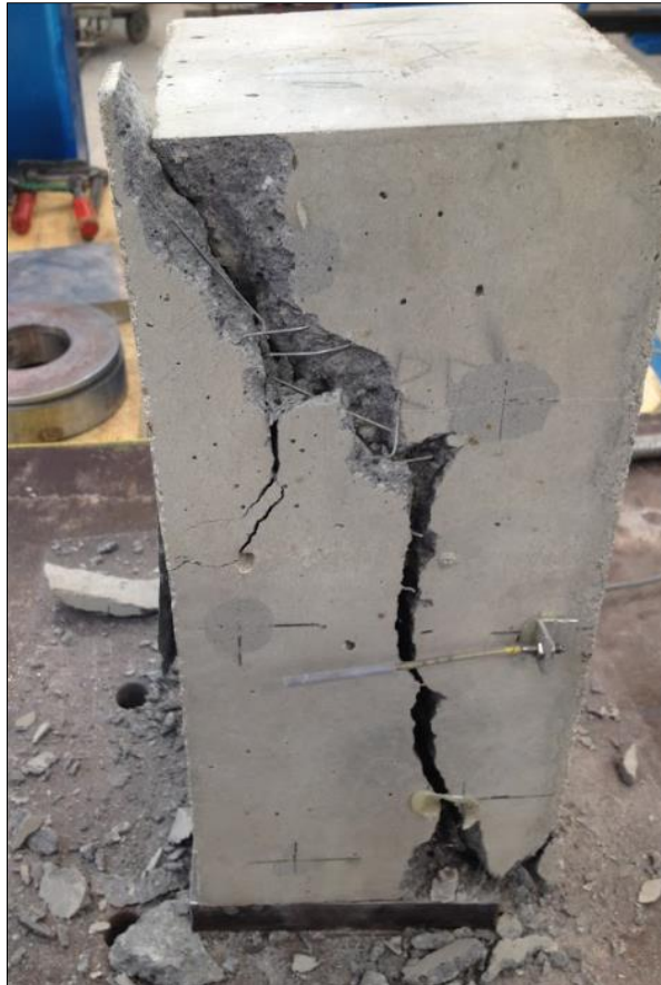
Figur 7.9: Prisme etter brudd
