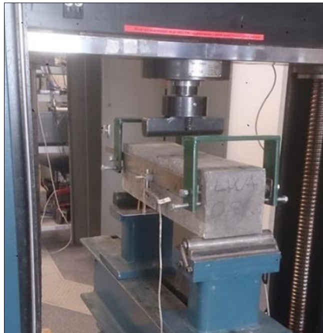
Figur 3.12: Oppsett av bjelketest
