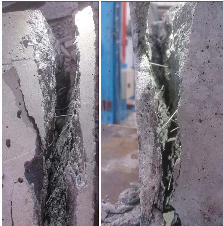
Figur 4.12: Bruddflate til normalbetong med 1% fiberinnhold
