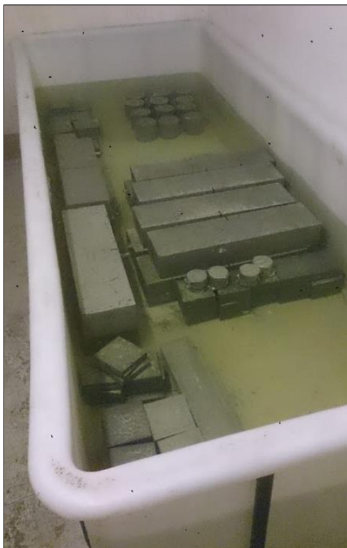
Figur 3.1: Vannbad med lagret prøvestykker
