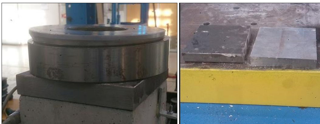
Figur 3.3: Sfærisk sylinder t.v. og metallplater t.h.
