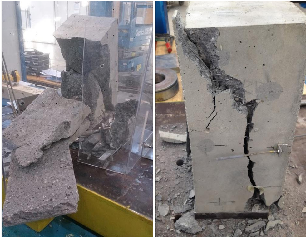
Figur 4.10: Bruddform for 0 % t.v. og 1 % fiberinnhold t.h.
