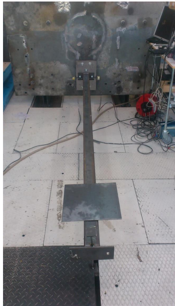
Figur 80: Søyle montert på vegg med plate for pålegging av vekter.
