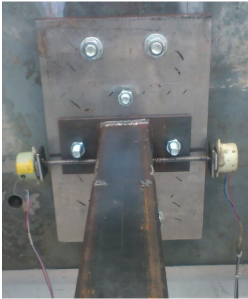
Figur 79: Forsøksoppsettet ved bøyning om svak (til venstre) og sterk akse.
