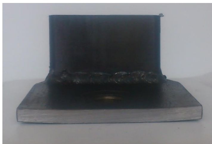
Figur 100: Deformasjonen sett bakfra.
