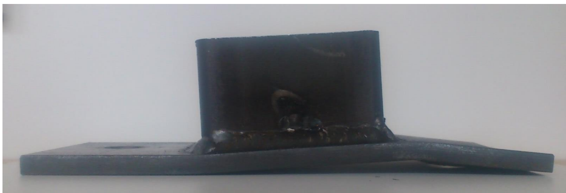
Figur 99: Deformasjonen sett fra siden.
