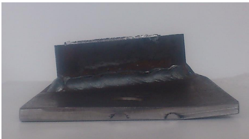
Figur 108: Deformasjonen sett fra siden.
