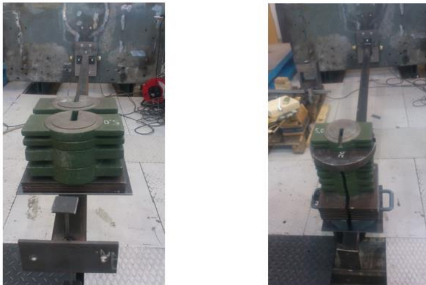
Figur 81: Bilde fra stivhetsforsøk om svak akse (til venstre), og fra kapasitetsforsøk om sterk akse.
