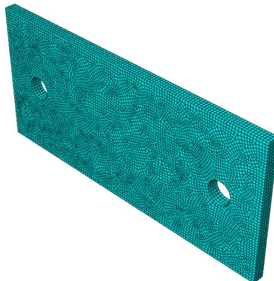
Figur 20: Elementinndeling til endeplate.
