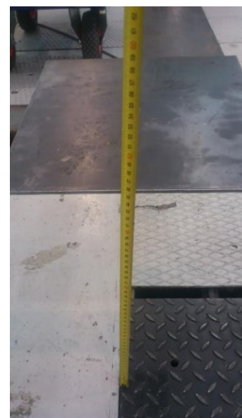
Figur 82: Måling av nedbøyning.
