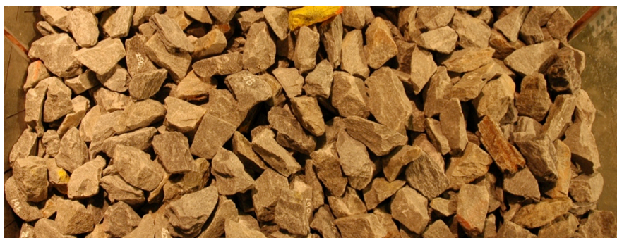
Figur 3.9 – Plastringssteiner lagt som rauset fylling
