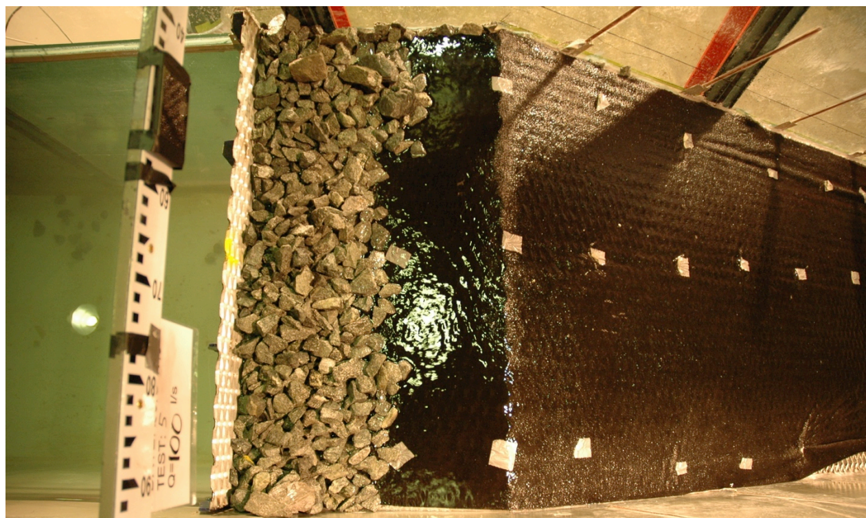
Figur E. 8 - Etter globalt brudd ved q=75 l/s/m
