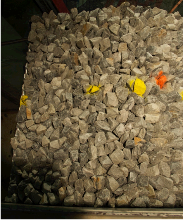
Figur A. 13 – Krone og knekkpunkt for plastringen utsettes for belastning
