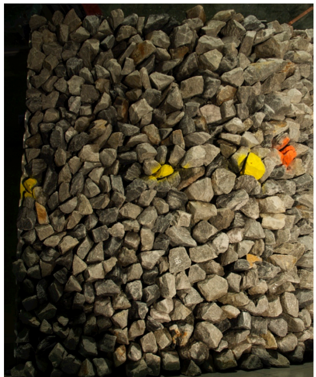
Figur A. 16 – Etter belastning med q=100 l/s/m
