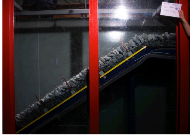
Figur A. 8 – Strømmingen gjennom filterlaget, q=7 l/s/m
