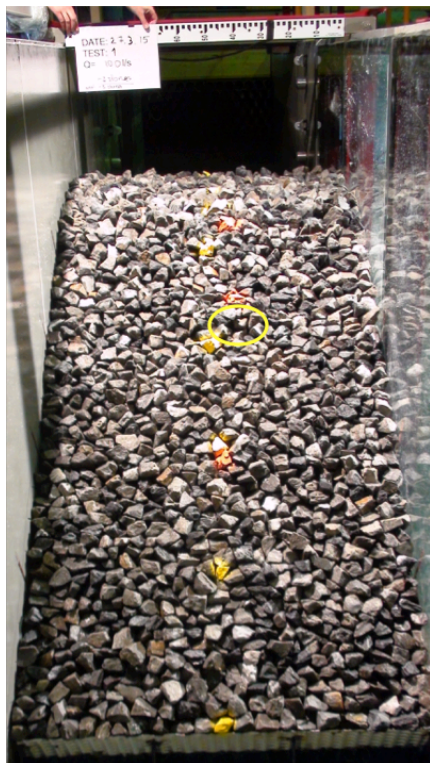
Figur A. 5 – Plastring etter belastning etter belastning med q=100 \text{ l/s/m}
