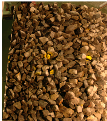
Figur 4.4 – Krone og knekkpunkt i forsøk 2 etter belastning med q=340 l/s
