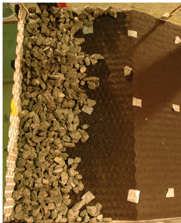
Figur D. 12 – Etter globalt brudd ved q=37 l/s/m
