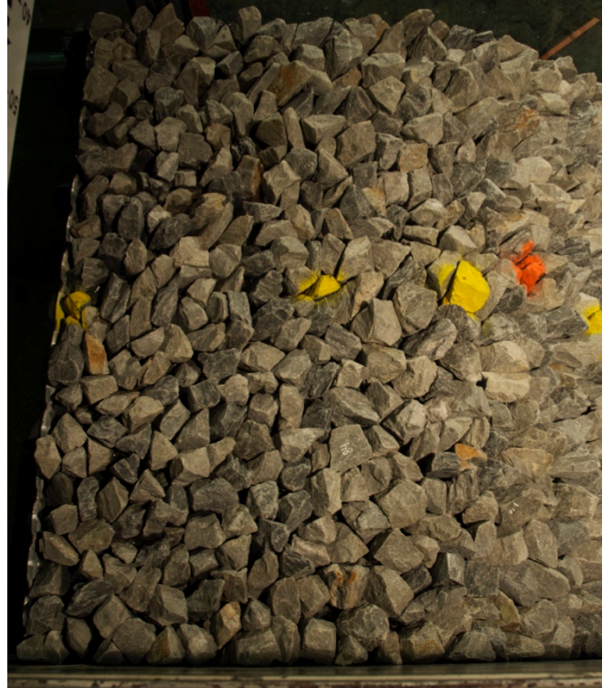
Figur A. 14 – Strømning gjennom filterlaget med q=7 l/s/m
