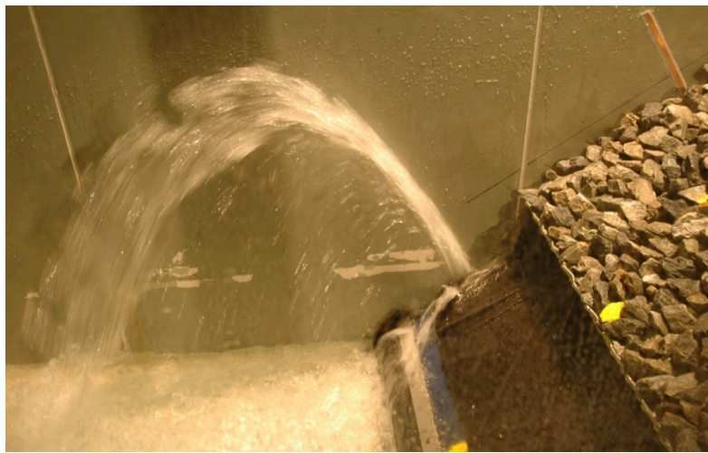
Figur B. 1 – Lekkasje nedstrøms plastringen
