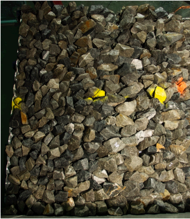
Figur A. 17 – Krone og knekkpunkt etter q=200 l/s/m
