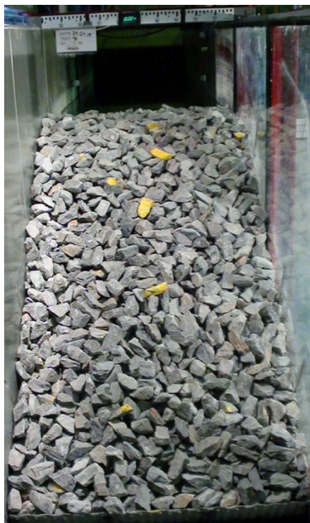
Figur D. 3 – Under q=6 l/s/m . Vann strømmer gjennom filterlaget
