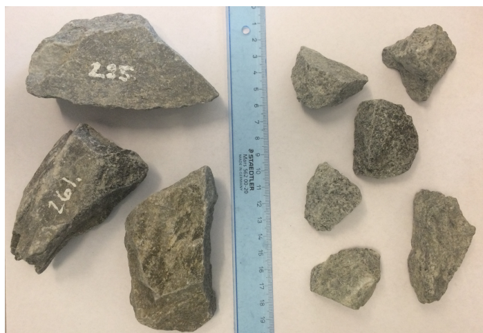
Figur 3.5 – Eksempel på plastrings- (venstre) og filterstein (høyre)
