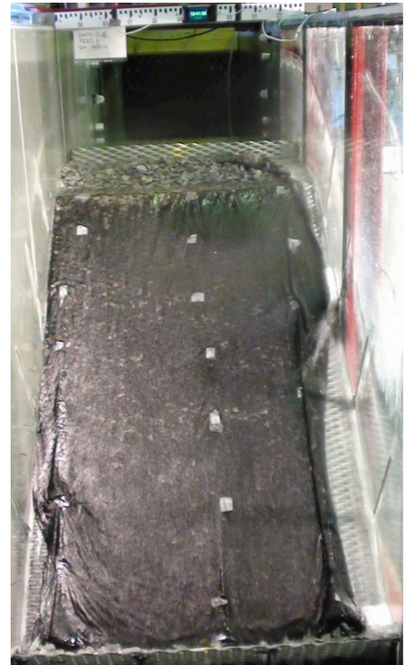
Figur F. 15 – Etter globalt brudd ved q=400 \text{ l/s/m}
