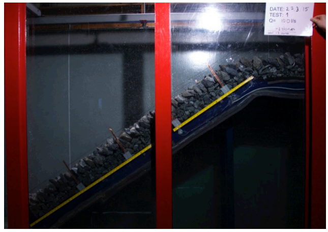
Figur A. 10 – Etter belastning med q=100 l/s/m. Tre steiner har blitt revet ut av plastringen
