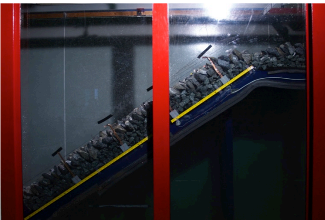
Figur A. 11 – Etter belastning med q=200 l/s/m.
