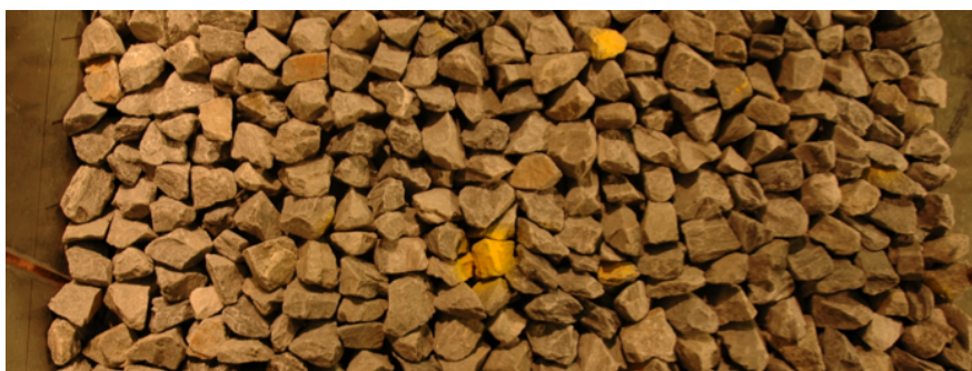
Figur 3.8 – Plastringssteiner lagt uten forband
