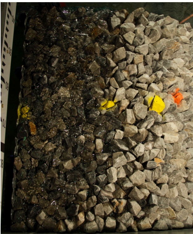
Figur A. 15 – Plastring med strømning gjennom filter- og plastringslag, q=12 l/s/m
