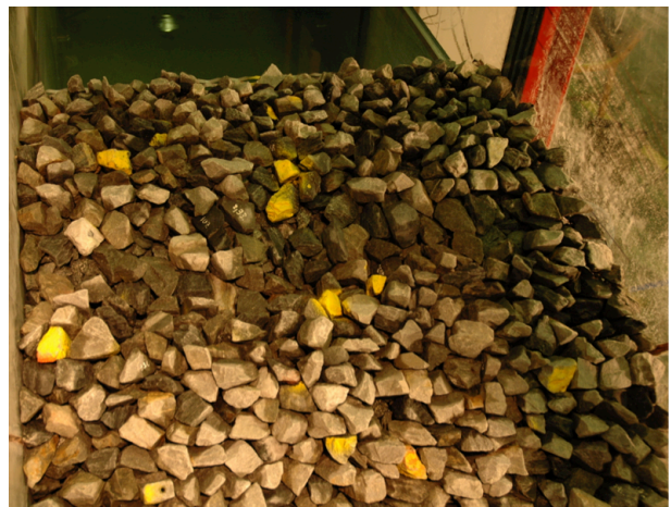
Figur F. 31 – Siste bilde for globalt brudd, 12.05.15
