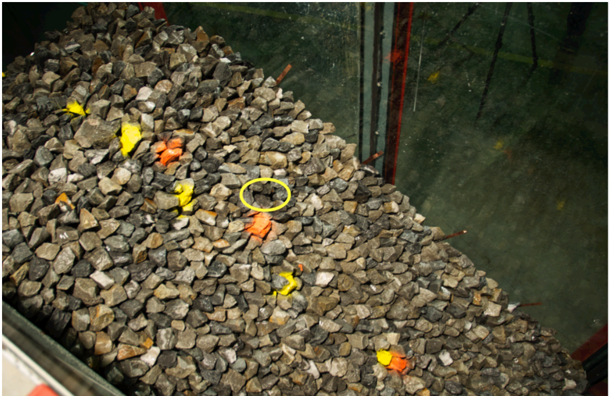
Figur A. 19 – Lokasjon av første stein som forsvinner ut av plastringen
