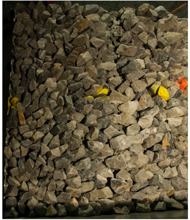
Figur A. 18 – Krone og knekkpunkt etter q=240 l/s/m
