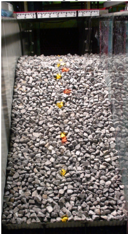
Figur A. 4 – Plastring før belastning
