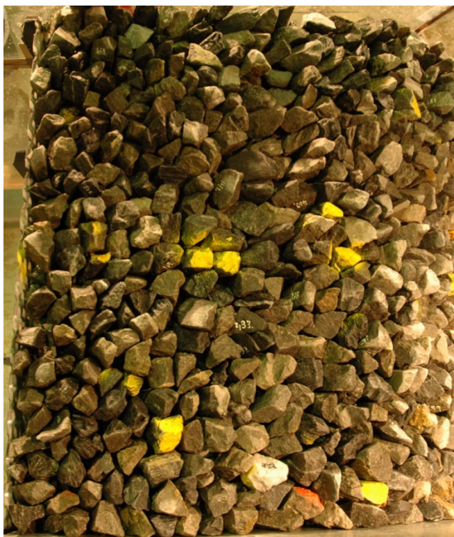
Figur F. 26 – Etter q=400 \text{ l/s/m} , 28.04.15
