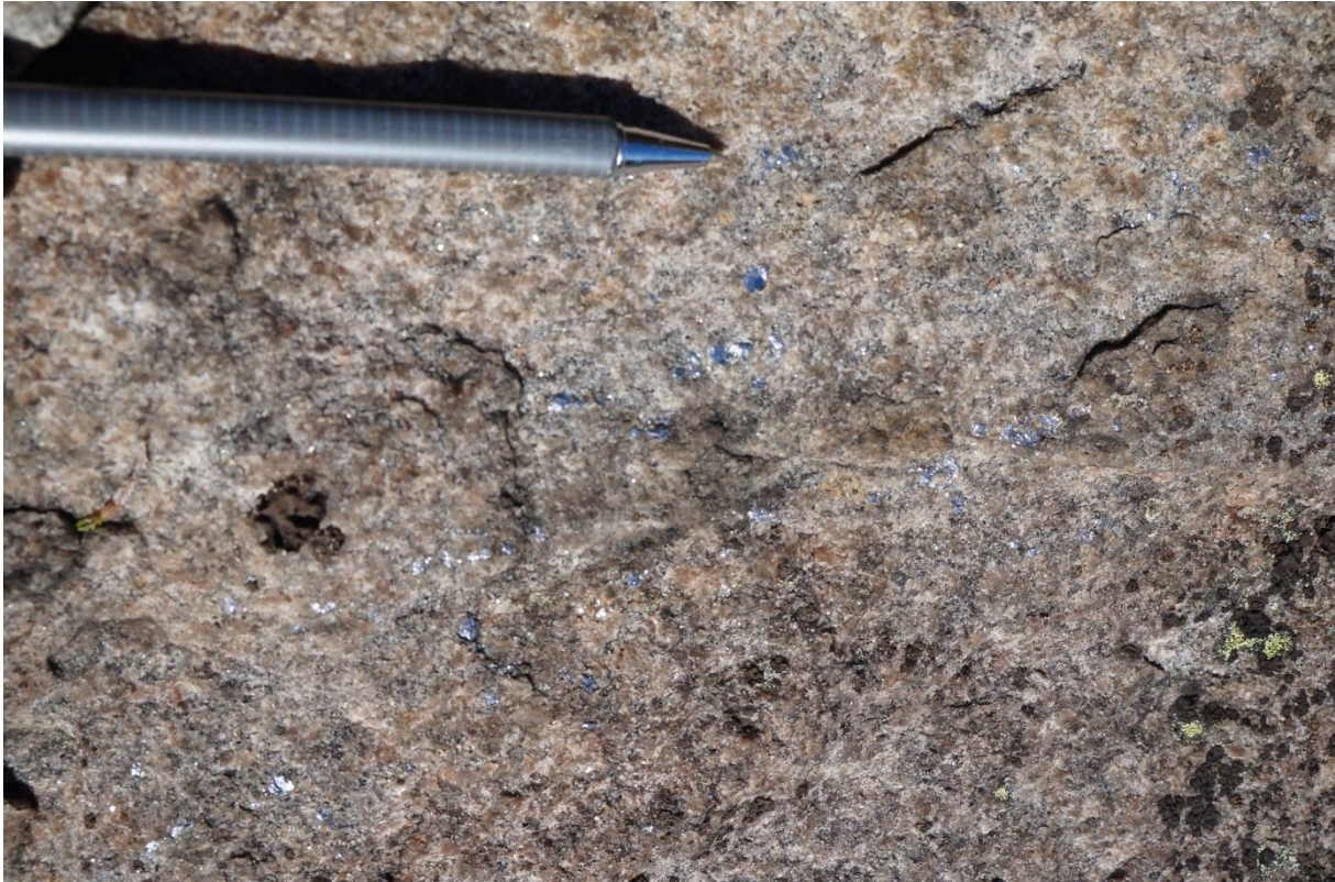
Figur 32 Prøve SØR 1.2 kommer fra en leukokratisk, mediumkornet, ekvigranular molybdenittførende granitt med svak foliasjon. Mediumkornet molybdenitt ligger orientert langs foliasjonsplanet.
