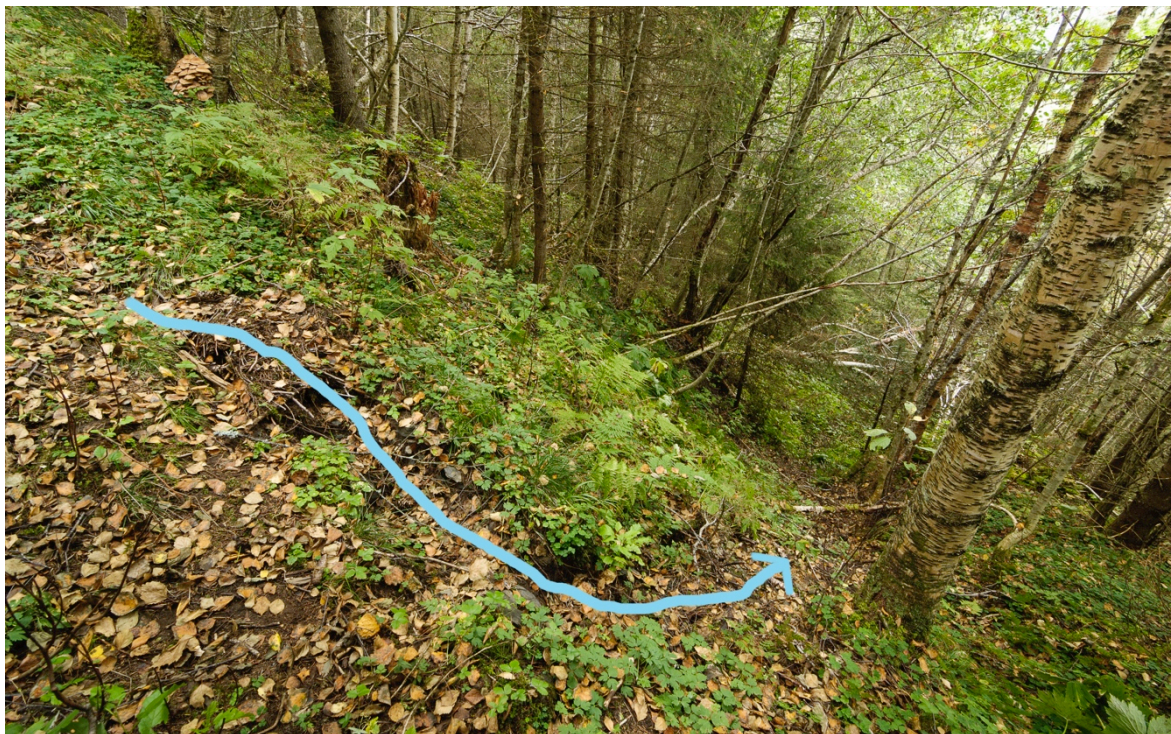
Figur 5.23: Blå strek er antatt vannvei. Vannveien følger sti før den svinger av ned skråningen ca. 20 m øst for skredet (Foto: Wenzel Prokosch, 11.09.2014).
