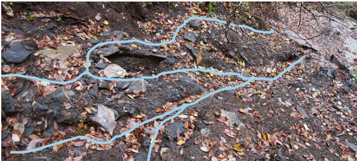
Figur 5.12: Blå streker er tolkede spor etter vannstrømninger i løsneområdet. Bildet er tatt i østlig retning ned skredbanen (Foto: Synne Tveiten, 24.09.2014).
