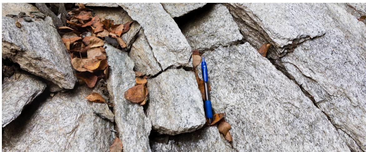
Figur 5.14: Flisige og stenglige blokker av glimmerskifer (Foto: Synne Tveiten, 11.09.2014).
