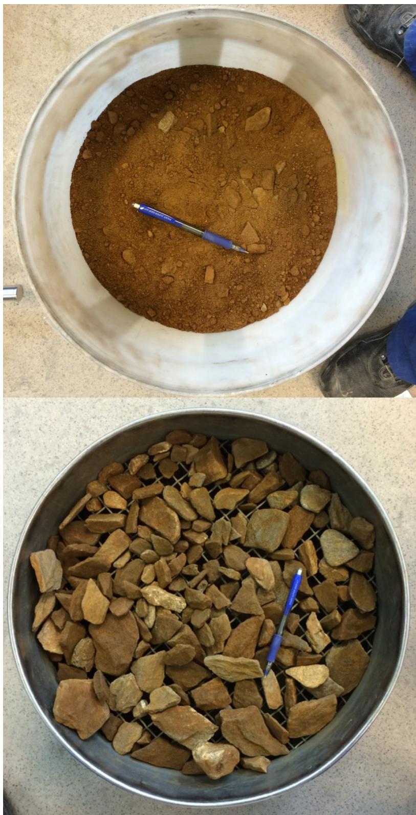
Figur 5.7: Separasjon av løsmasseprøve fra skredsåret i Almåskroken. Øverst: kornfraksjoner mindre enn 16 mm. Nederst: kornfraksjoner større enn 16 mm. Disse fraksjonene kan beskrives som kantet-kantrundet (Foto: Øysten Lid Opsal, 14.04.2015).
