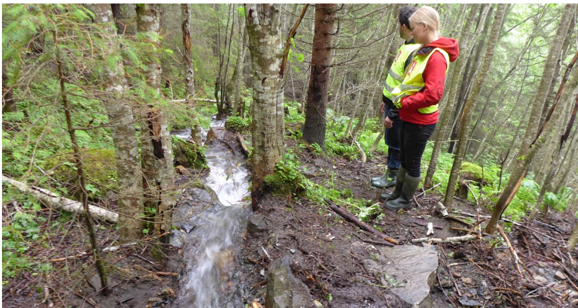
Figur 6.1: Vannføring i bekken under befaring 23. juni 2014. De brune områdene til høyre i viser tydelig hvordan vann har rent nedover skråningen og erodert. Bildet er tatt mot nordøst (Terje H. Bargel).
