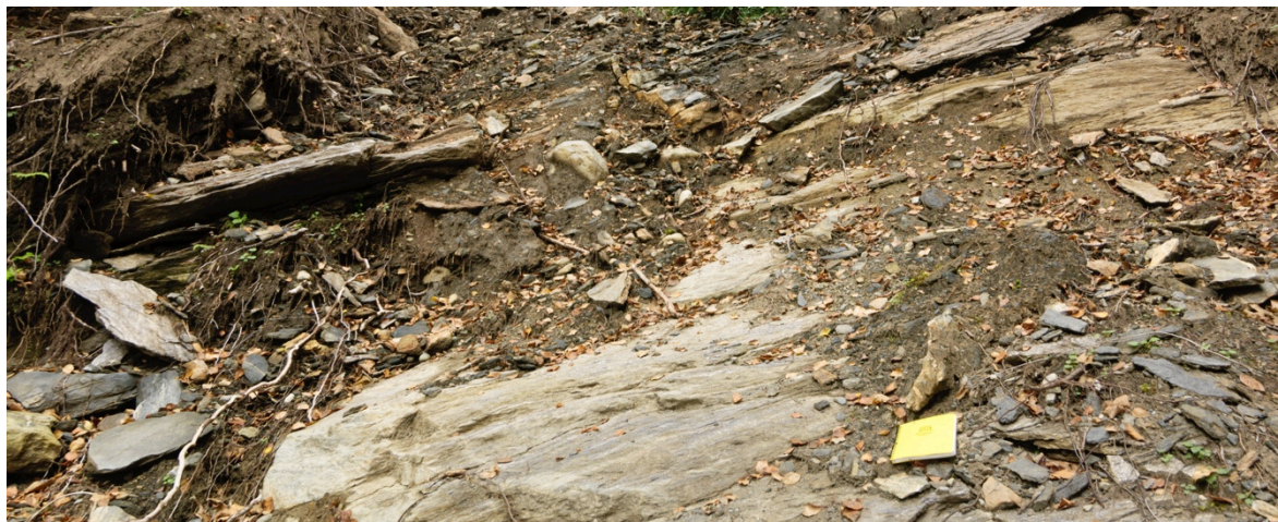
Figur 5.13: Massiv bergart til høyre i bildet er glimmergneis. Øverst til venstre: glimmerskifer med lagdeling ned mot dalbunnen. Bildet er tatt oppover i skredbanen (Foto: Wenzel Prokosch, 11.09.2014).
