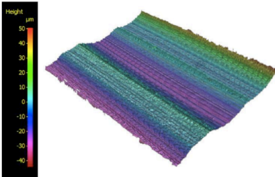
Figur 30: Viser 3D-bildet av punkt X_3 (rødt kryss) på den endeplanfrest prøven fra SINTEF (B1). Til venstre er fargeindeksen.
