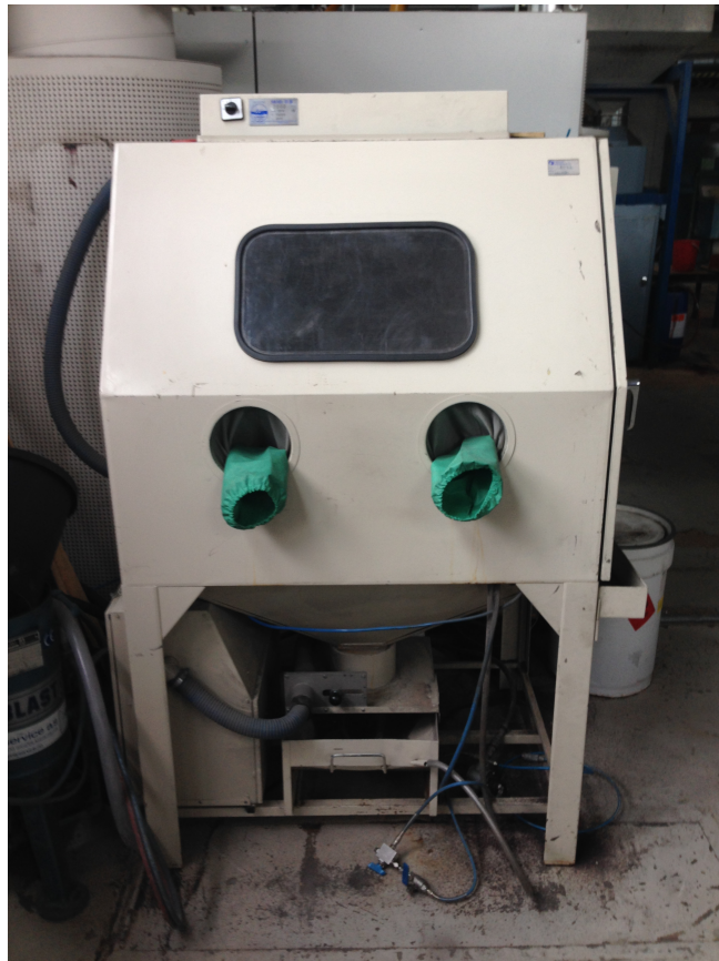
Figur 16: Apparatet benyttet for å blåserense prøvene B2, B3 og B4 med \text{Al}_2\text{O}_3 . Apparatet tilhører SINTEF, og blåserensing ble gjort selv.
