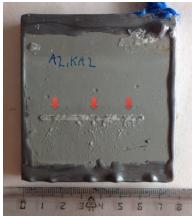
Figur 44: Viser en endeplanfrest prøve fra SINTEF (B1), før løst belegg ble fjernet. Røde piler viser kalkutfellinger ut fra det eksponerte stålområdet. Merking på prøven kan sees bort fra.
