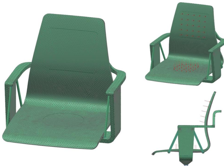
Figur 3.13. FE-modell samt laster for andre lastsituasjon.
