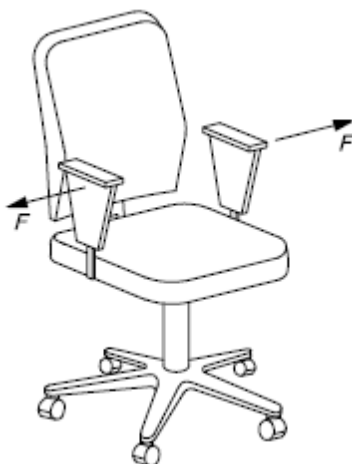
Figur 1.5. Test av armlen med laster rettet utover.
