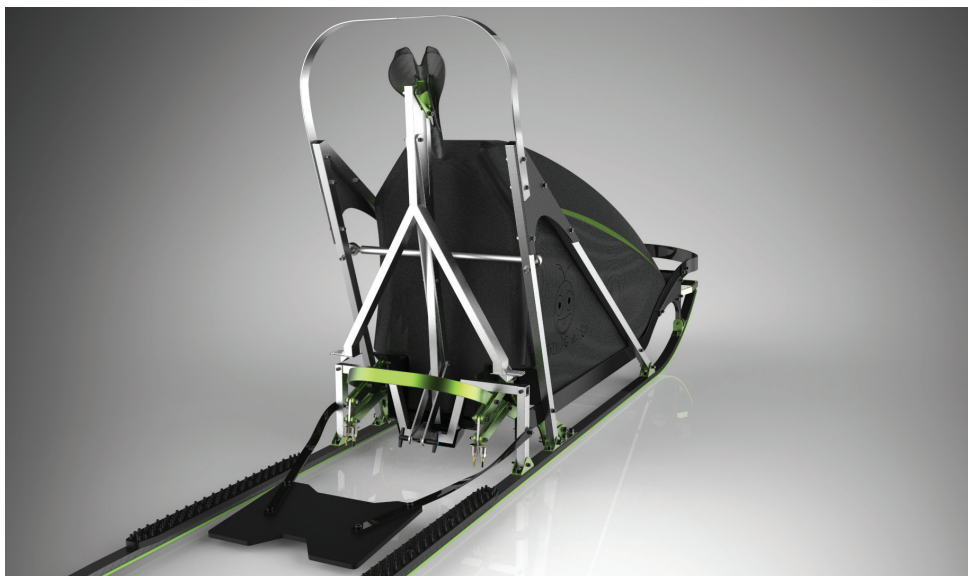
Figur 3.37: Brems og sete etter rendering av CAD-modell
