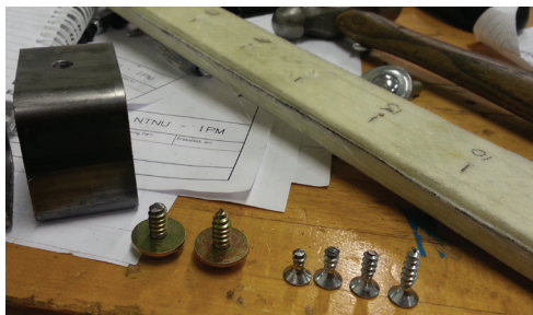
Figur 4.37: Testutstyr med skruer, teststykke og bøyle
