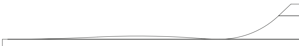
Figur 4.26: Profilen på skiformen og styrken av skien bestemmer spennet
