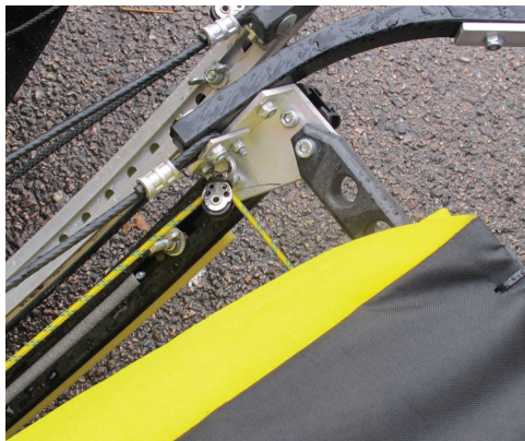
Figur 2.15: Trinsesystem for økt styrbarhet
