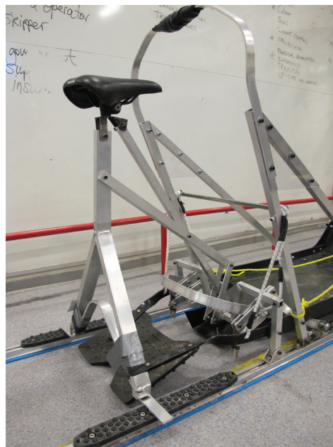
Figur 3.39: Nedfelt sete på prototype
