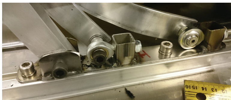
Figur 3.41: Brakett for innfesting av bukk (lengst til venstre) og brems
