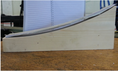
Figur 4.50: Springback av testbit støpt i form
