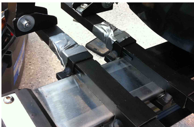
Figur 26 Vridning av brakettene brukt på ryggstøttestrukturen, legg merke til sølvteip brukt for å ha fastholding av den ene braketten.
