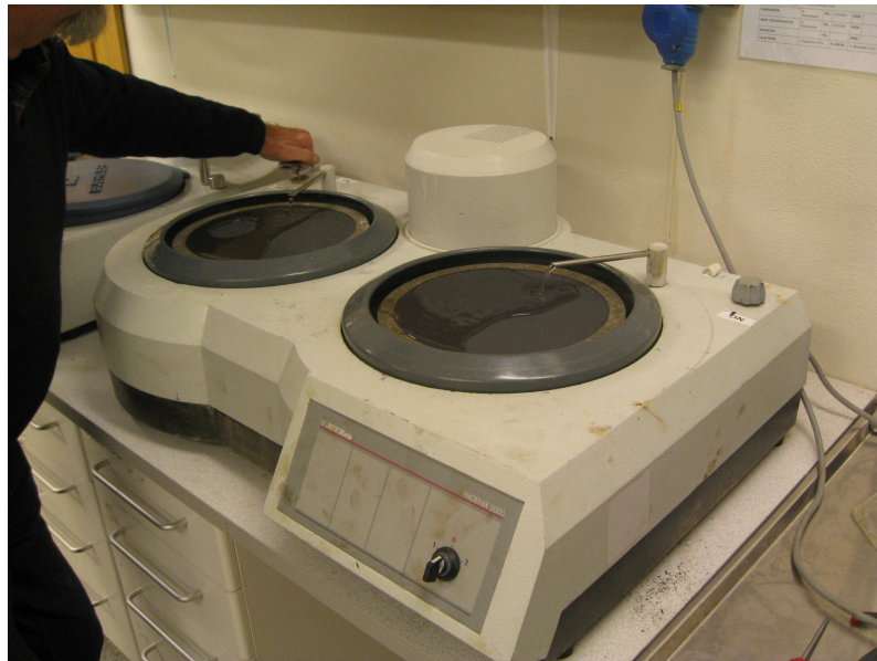
FIGUR 4.21: Poleringsmaskinen har to roterende plater med poleringspapir av forskjellig fin/grovhet. Disse blir under drift tilført vann.
