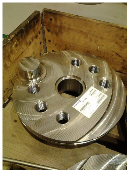
FIGUR 1.1: Ferdig maskinert tappskive fra Rolls-Royce Marine. [7]
