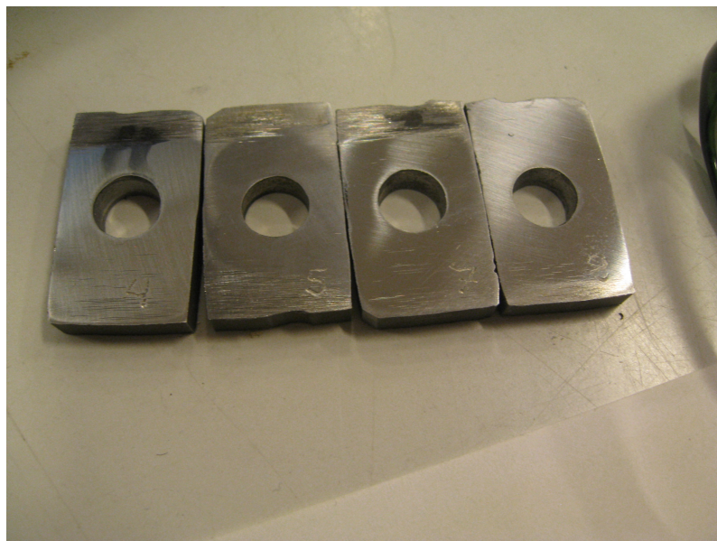
FIGUR 4.22: Et utvalg prøver ferdig polert og klar til bøyetesting.
