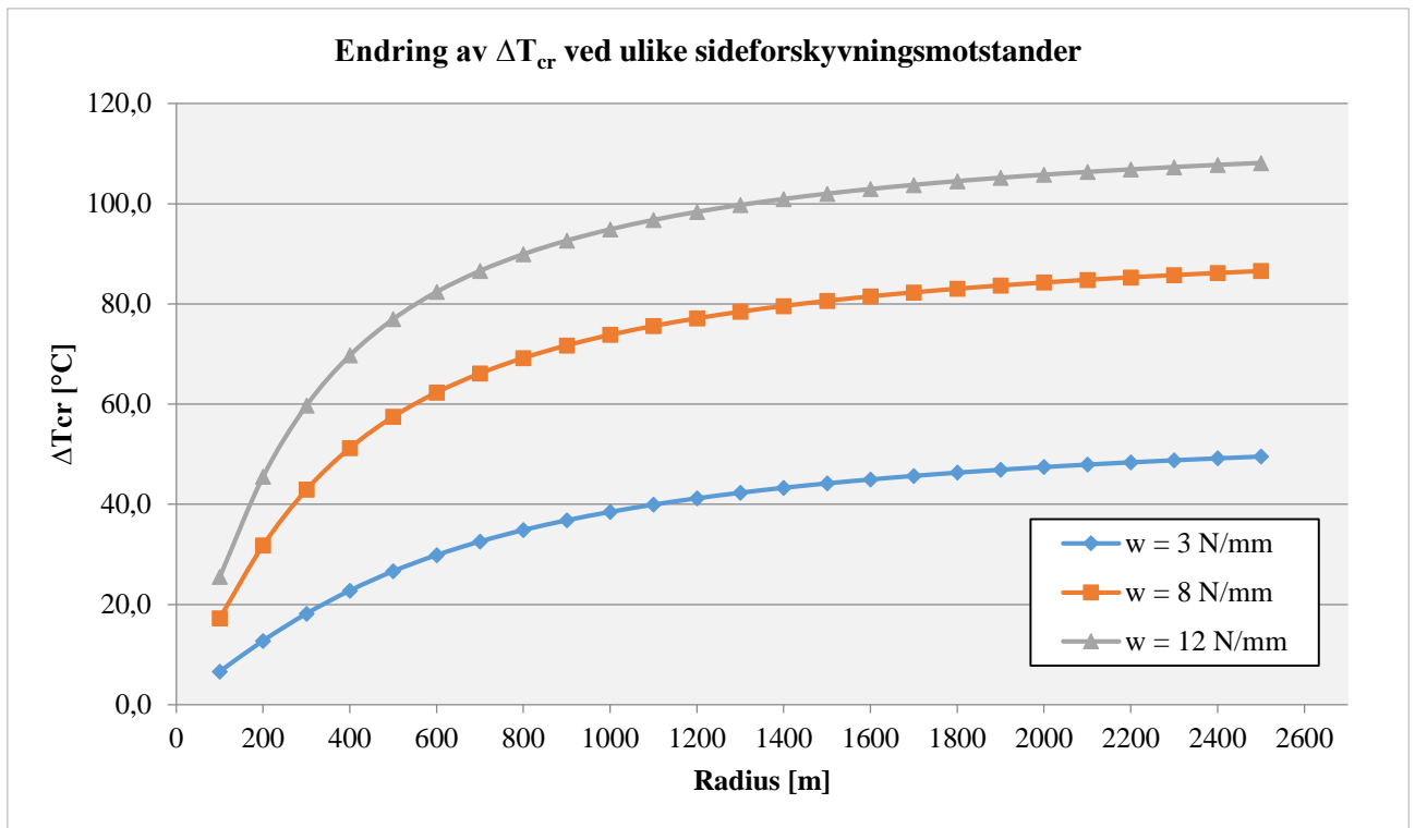
Figur 7: Endring av kritisk temperaturøkning ved ulike w og radier
