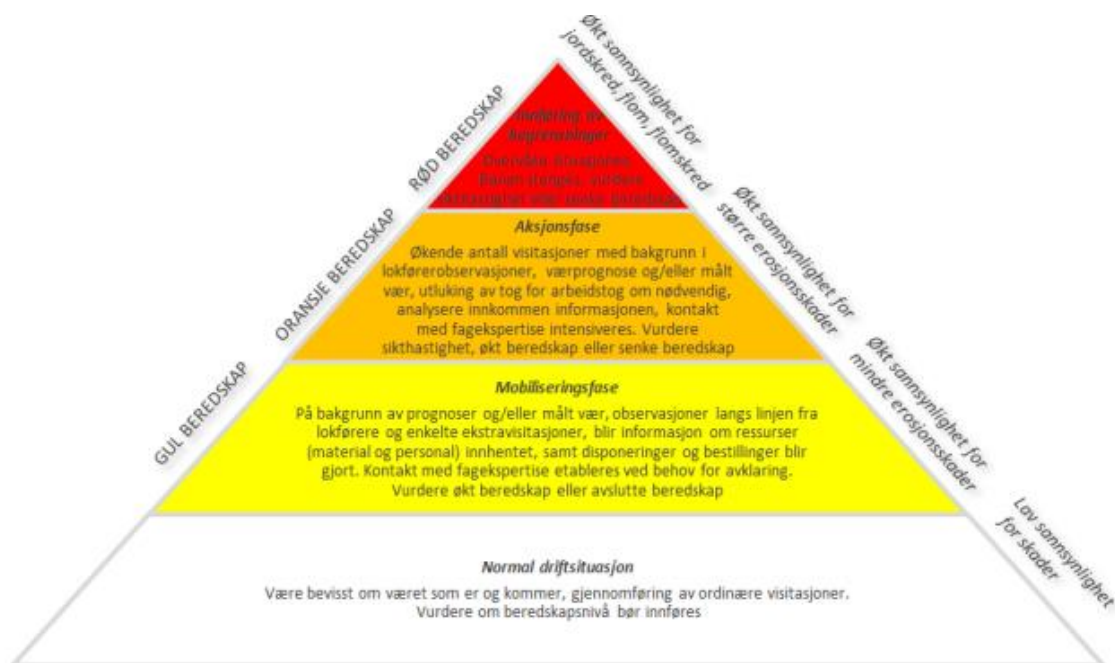
Figur 5: Skisse av beredskapssystemet for nedbør og snøsmelting (Karlsen 2012)
