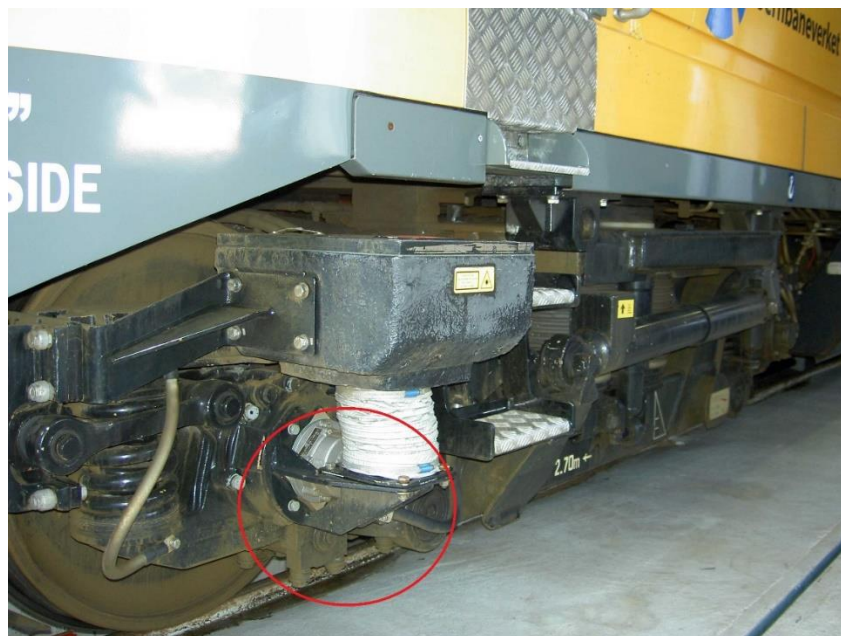
Figur 5.3 - Plassering av måleutstyr på Roger 1000 Foto: Geir Harald Ingvaldsen, Jernbaneverket
