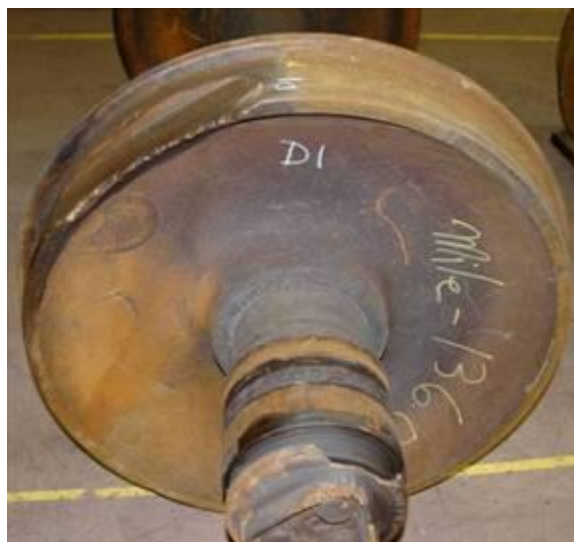
Figur 4.12 - Eksempel på hjulslitasje på et kanadisk hjul. Denne type skade vil forårsake hjulslag (The Transportation Safety Board of Canada, 2013)
