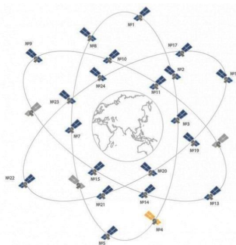
Figur 2: Illustrasjon av romsegmentet til GLONASS, hentet fra (4).
