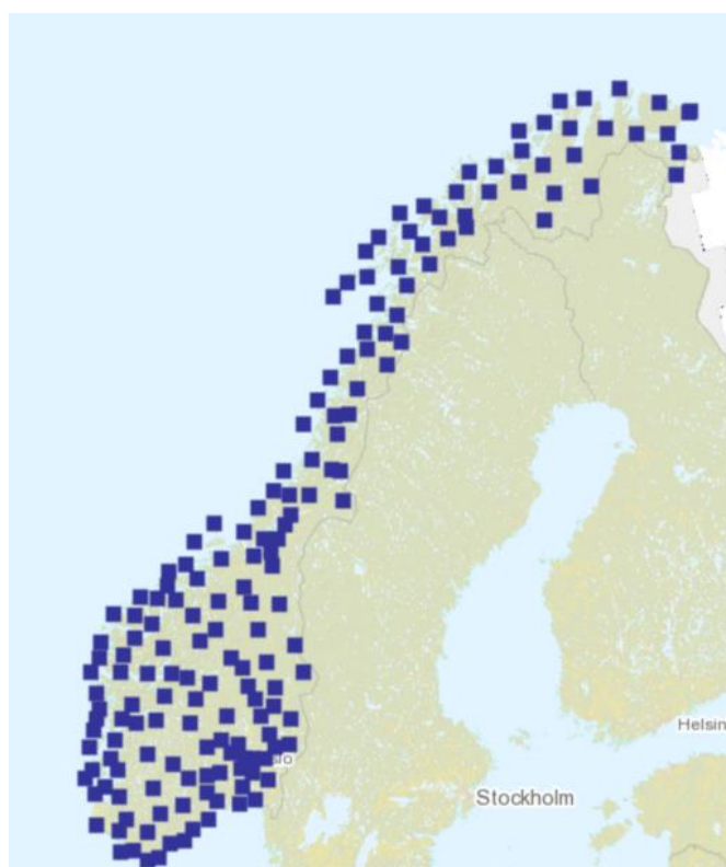
Figur 8: Figuren viser det nasjonale nettverket med målestasjoner som danner grunnlaget for CPOS. Basert på Norgeskart (2015)
