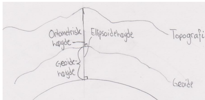
Figur 12: Ortografisk høyde, ellipsoidisk høyde og geoidhøyde
