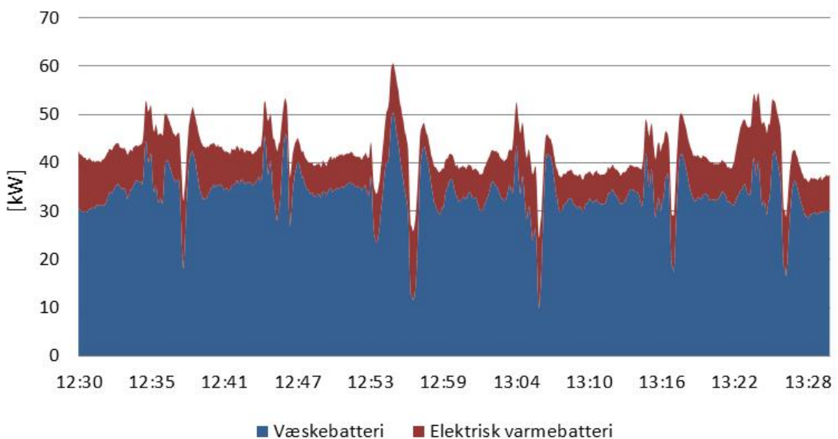
Figur 4.14 Beregnet effekt i væskebatteri og elektrisk varmebatteri (12.30-13.30, 12.3.2012)
