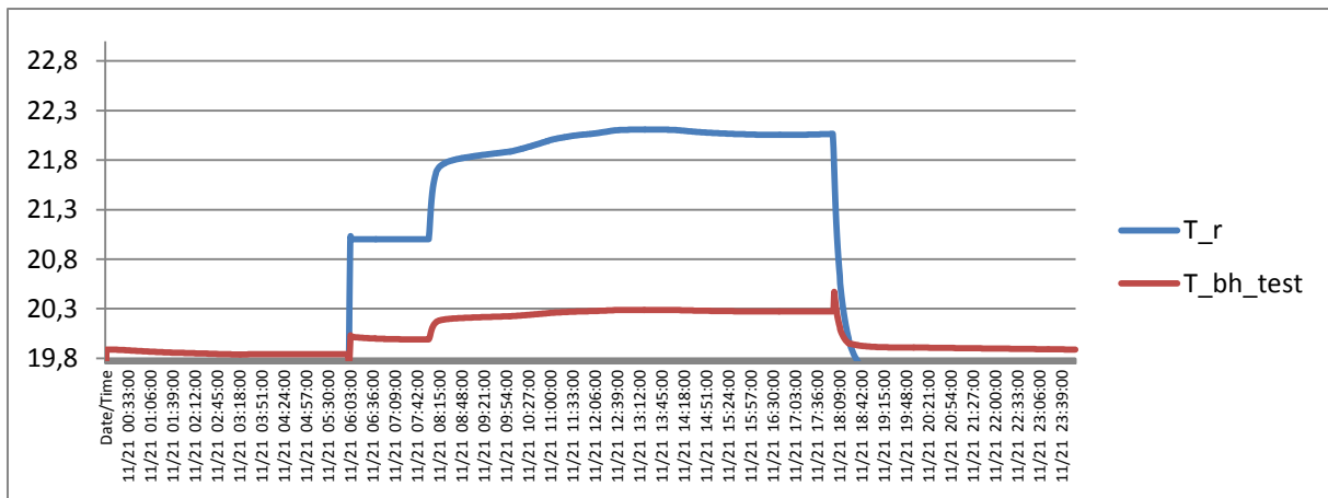
Figur 57 Aluminiumshimling: Sammenligning av av romtemperaturen og overflatetemperatur gitt av varmebalanse
