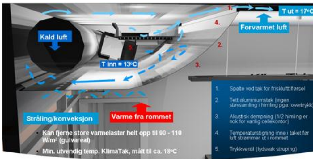
Figur 25 - KlimaTakets prinsipp og virkemåte
