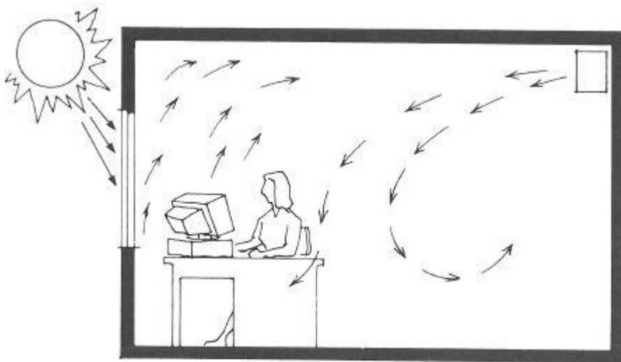
Figur 14: Omrøringsventilasjon med tilluftsdon i bakkant av rommet (Skåret, 2000)
