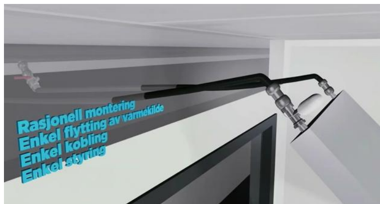
FIGUR 14 YIT'S LØYSING MED FLEKSIBEL TILKOBLING AV STRÅLEPANEL
