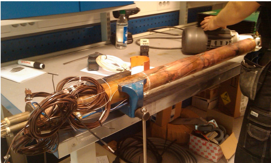
Figur 6-6, Ferdig monterte termokoblinger
