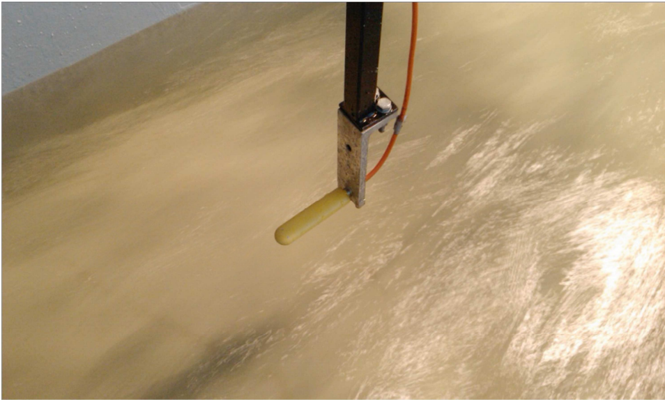
Figur 7-7, Probe for ultrasonisk hastighetsmåler
