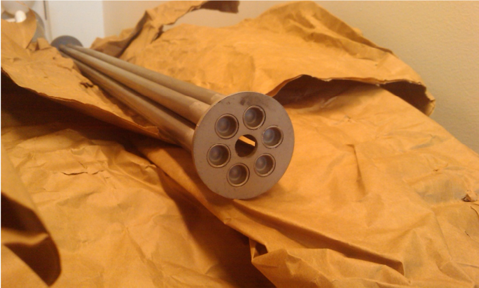
Figur 6-2, Bunnflens med fyllhull for tinn på leverte varmeelementer
