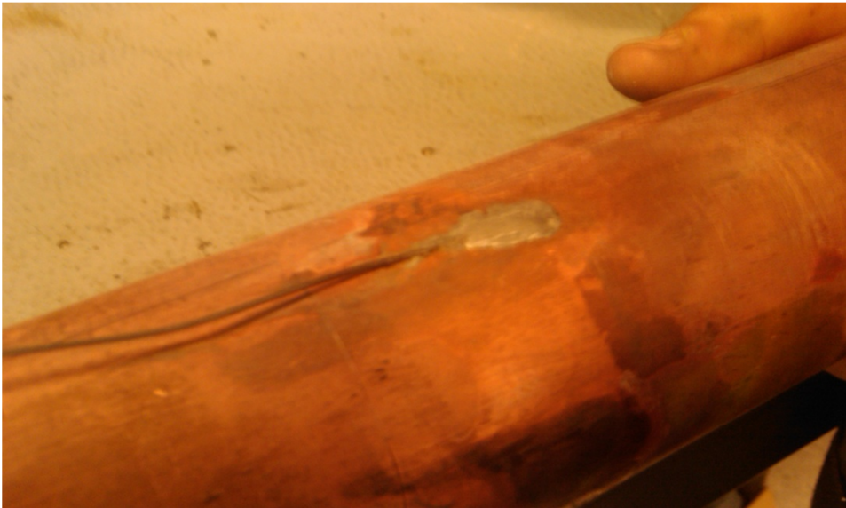
Figur 6-7, Termokobling loddet til rørveggen
