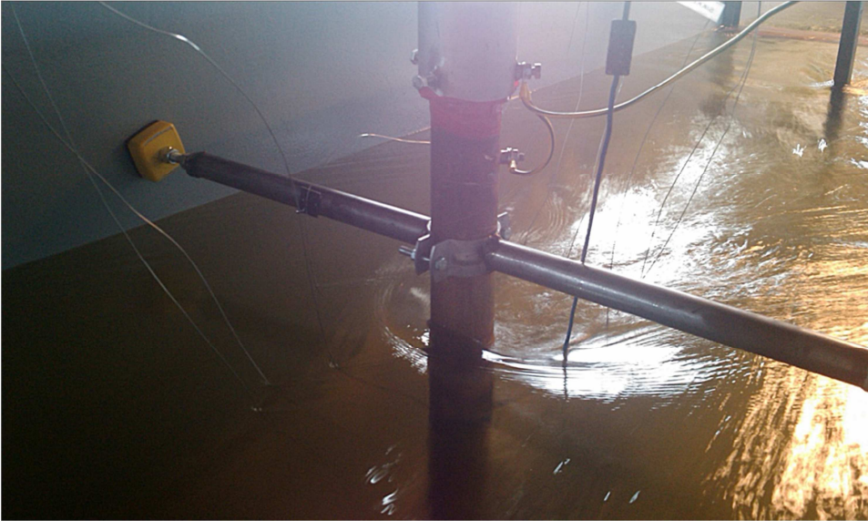
Figur 9-4, Forsøksriggen med en vannhastighet på 0,2 m/s
