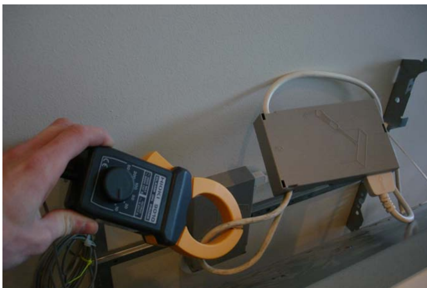
Figur 2. Løsning for tilkobling av tangamperemeter.
