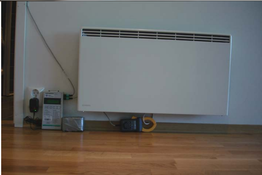
Figur 3. Panelovn med måleutstyr og logger.
