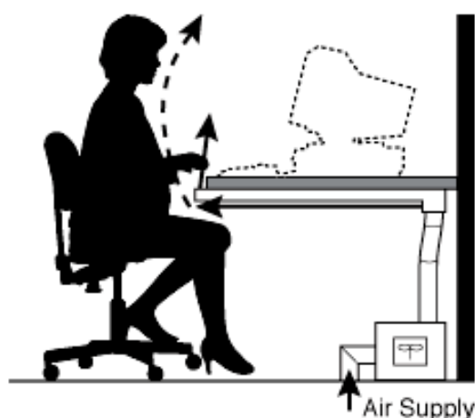
Figur 63: Personlig ventilasjon, type "vertical desk grill"[64]
