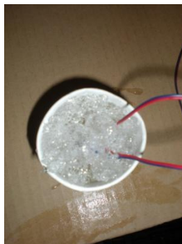
Figur 25 Kalibrering av termoelement i isvatn
