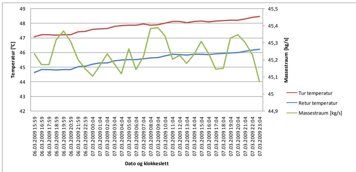
Figur 33 Målte verdier av massestrøm, tur- og returtemperatur inn/frå kondensatoren midla over ein time frå 6. til 7. mars 2009 for R134a-varmepumpa
