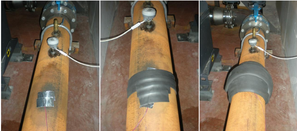
Figur 26 Montering av termoelement i hall 16
