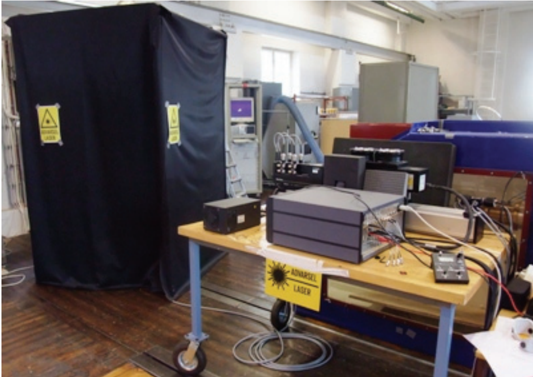
Figur 3-6 – Strålingsbeskyttelse rundt testseksjonen og LDV-utstyr
