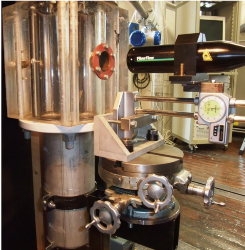
Figur 3-5 – Bilde av stativ og travers med laserprobe montert på testseksjonen
