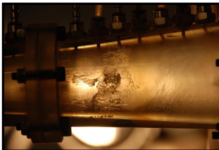
Figur 7.9: Isdannelse ved støt ved "minimalt" med damp.
