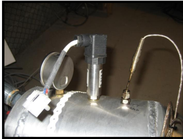
Figur B.4: Plassering av trykk og temperatur sensorer.
