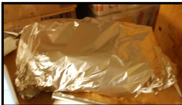
Figur 6.11: Skjerming av koblingsbrett med aluminiumsfolie.
