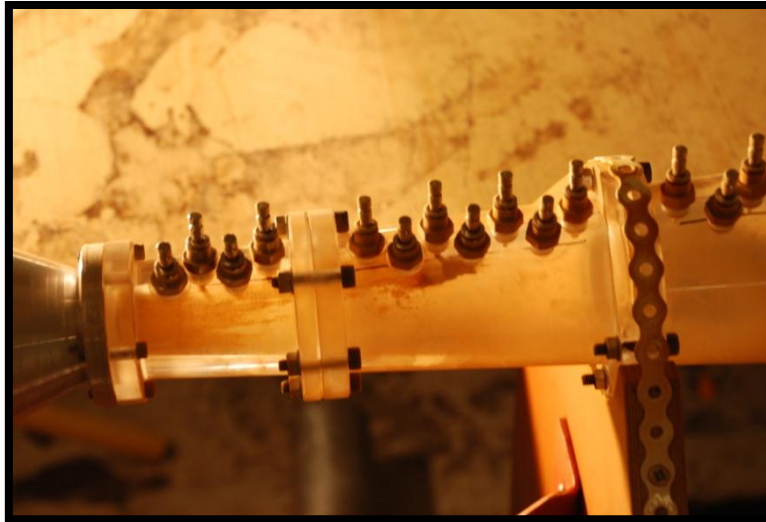
Figur 7.5: Rustpartikler i dysen etter forsøk.
