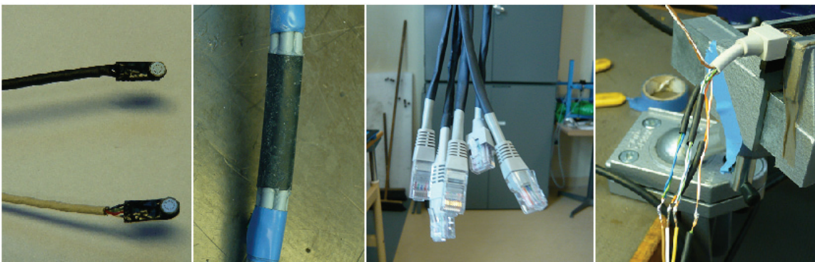
Figur 3-8: Fra venstre; Sensor med og uten krympestrømpe, silikonplugg, RJ-50 plugg, kobling RJ-50 til sensor-kabel.
