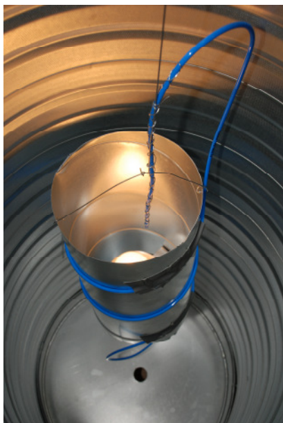
Figur 7-4: Modell av et barn innenfra. Bildet viser den indre sylindren med en lyspære inni, samt den blåe kabelen for CO 2 tilførsel
