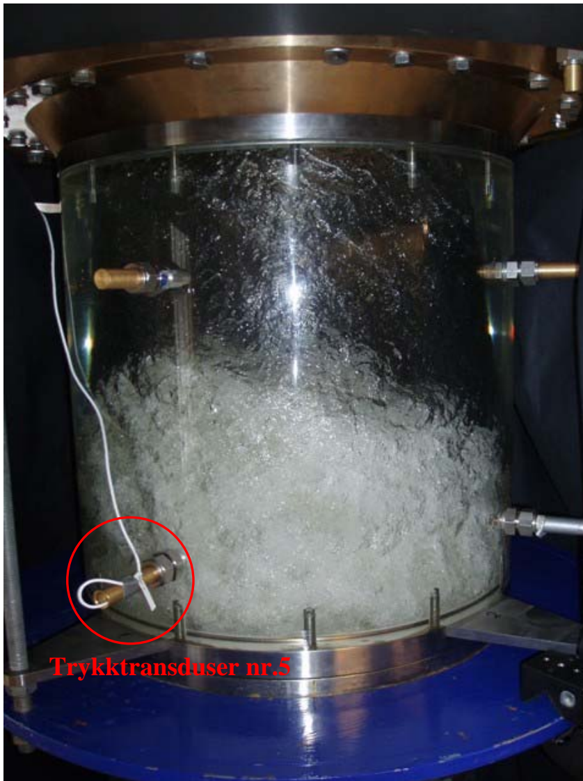
Figur 4-22. Bilde av sugerørskonusen ved trykktransduser nr.5 ( \alpha = 4^\circ ).
