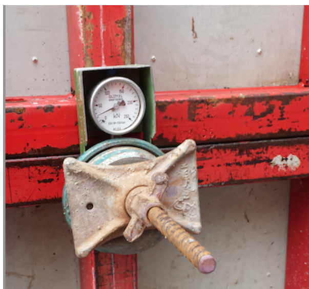
Figur 3.11: Apparat for kontroll av betongens trykk
