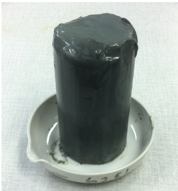
Figur 5.9: Espforsøket etter det er bygd ut av apparatet og plassert opp ned, slik at bunnen er på toppen. Deler av bunnen var mykere enn normalt, som vises godt på prøven.
