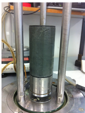
Figur 3.9: Ferdig trimmet prøve montert på pidestall med mettede filtre i begge ender.
