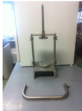
Figur 3.7: Tråsåg foran stativet som brukes til å trimme materialet til 54 mm-prøve.
