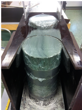
Figur 3.5: Stativet materialet står på under oppdeling og visuell inspeksjon av materialet.
