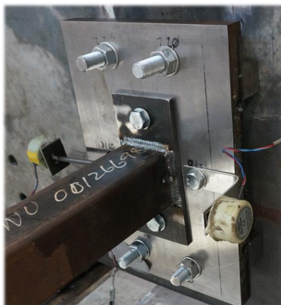
Figur 7.5: Kontroll av bakplatens stivhet.
