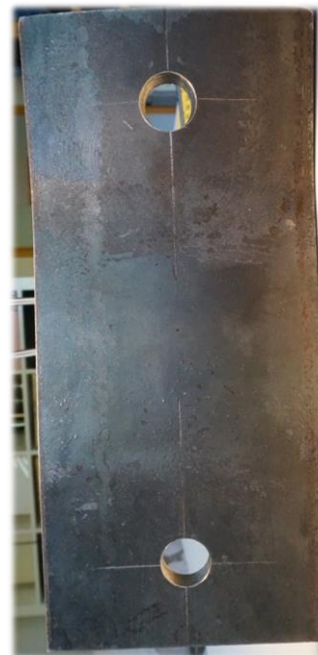
Figur 9.19: Endeplaten kontakflate etter kapasitetsforsøket med last langs Y-aksen.
