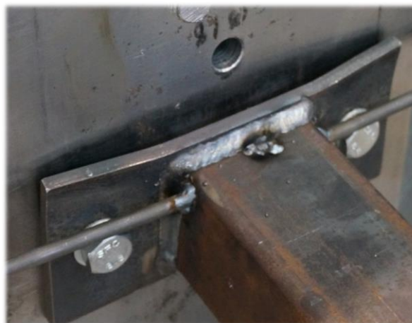
Figur 9.26: Deformasjonene av endeplaten ved makslast på 180 kg.
