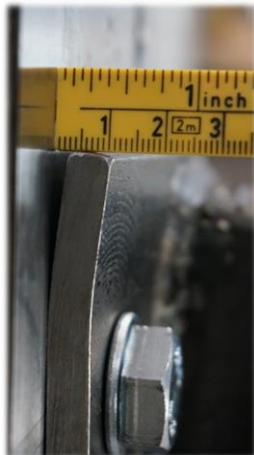
Figur 9.34: Kontaktområde ovenfor boltene og utbøyning av endeplaten.
