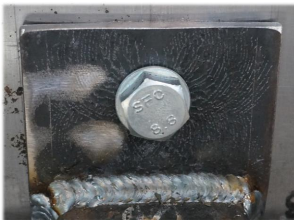
Figur 9.7: Oversiden av forbindelsen ved 250 kg.
