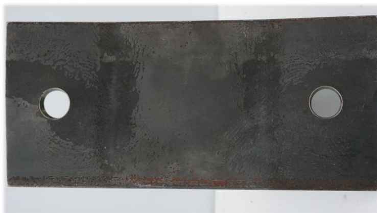
Figur 9.35: Endeplatens kontaktflate etter kapasitetsforsøket med last langs Z-aksen.
