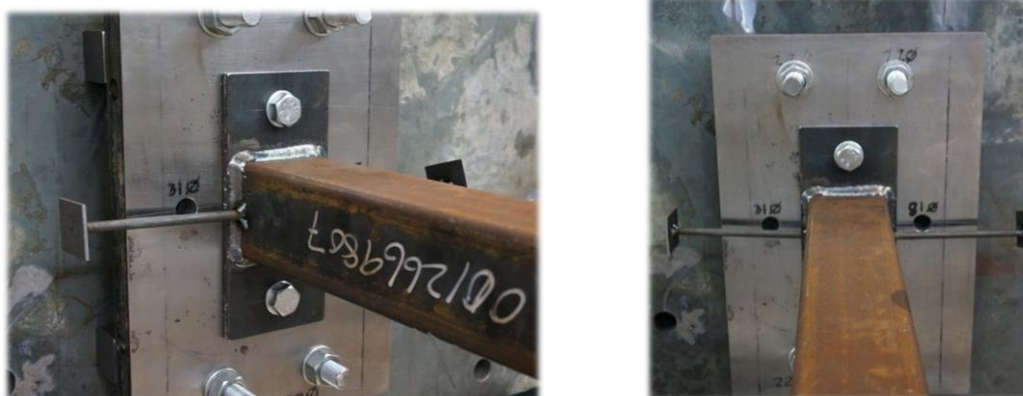
Figur 7.7: Ferdig montert søyle for gjennomføring av forsøket med belastning i Y-retning.
