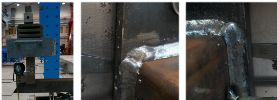
Figur 7.13: Utførelse av avlesning med bladmåler for serie 6 påkjent av makslast på 87,5kg.
