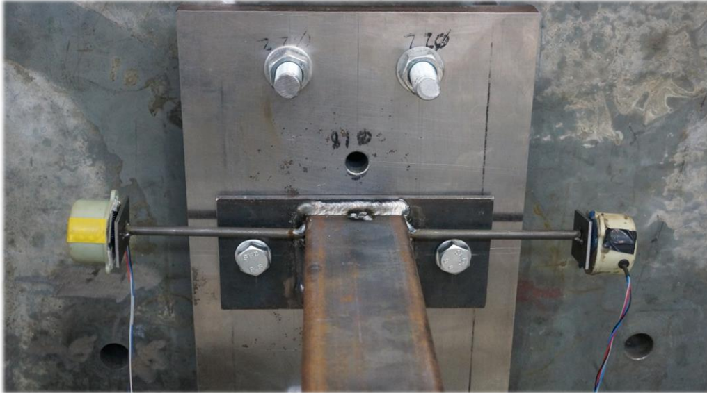
Figur 7.8: Ferdig montert søylefot for belastning i Z-retning.
