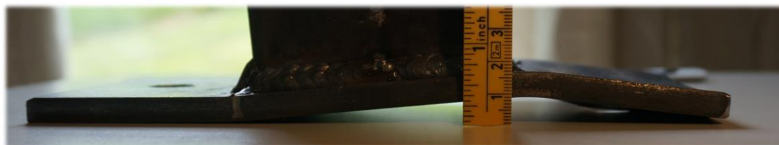
Figur 9.20: Endeplaten plastiske deformasjoner. Oversiden av forbindelsen er vist til høyre.
