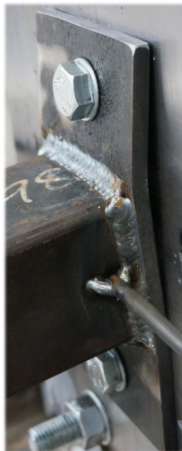
Figur 9.8: Fasong på endeplaten under påkjenning av 250 kg.
