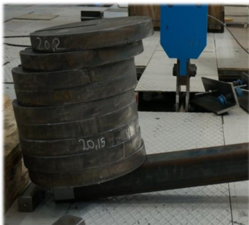
Figur 9.25: Profilet tok i bakken ved en belastning på 180 kg.
