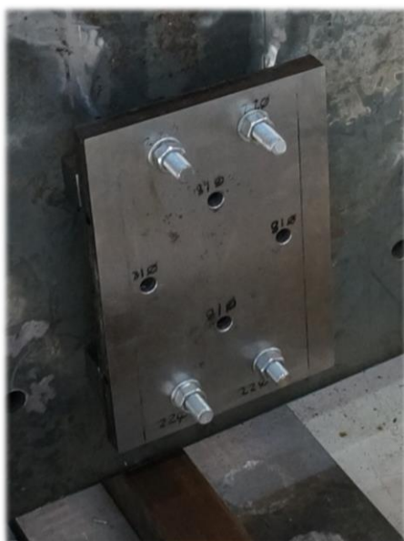
Figur 7.4: Bakplaten av stål på 30mm.
