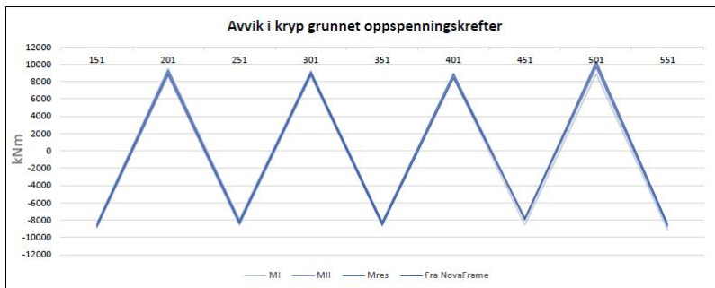
Figur 8.11: Avvik i kryp grunnet oppspenningskrefter
