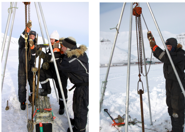
Figur 3.3: Oppsett av prøvetakningsutstyr. Til venstre: Nedpressing av prøvetaker. Fra venstre, Martin Dons, Vetle K. Stene og Jomar Finseth. Til høyre: Forsiktig opptrekk av prøvetaker.
