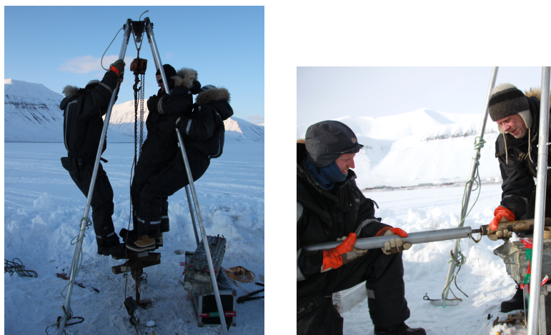
Figur 3.4: Utførelse av prøvetaking. Til venstre: Nedpressing av prøvetaker ved siste prøve. Til høyre: Frakobling av prøvesylinder fra prøvetaker.
