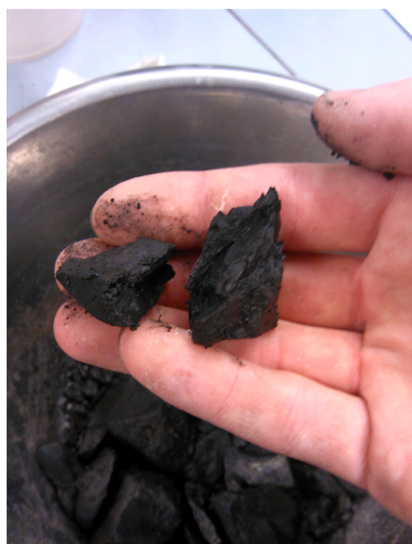
Figur 6.10: Fraksjon av fyllingsmaterialet knust med en hånd. Foto: Martin Dons.
