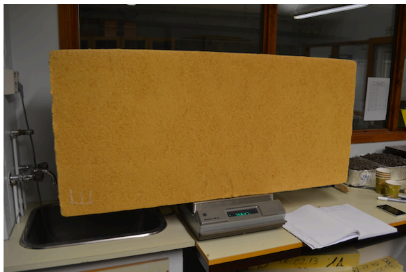
Figur 22: Veiing av 200mm Flex isolasjonsplate under kondisjonering.
