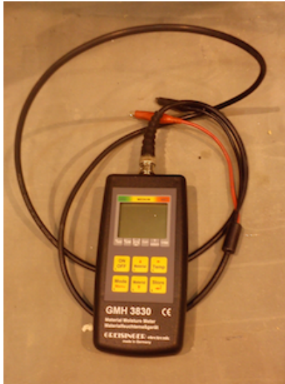
Figur 28: Bærebær elektronisk fuktmåler, GMH 3830, brukt til trefuktmålinger.
