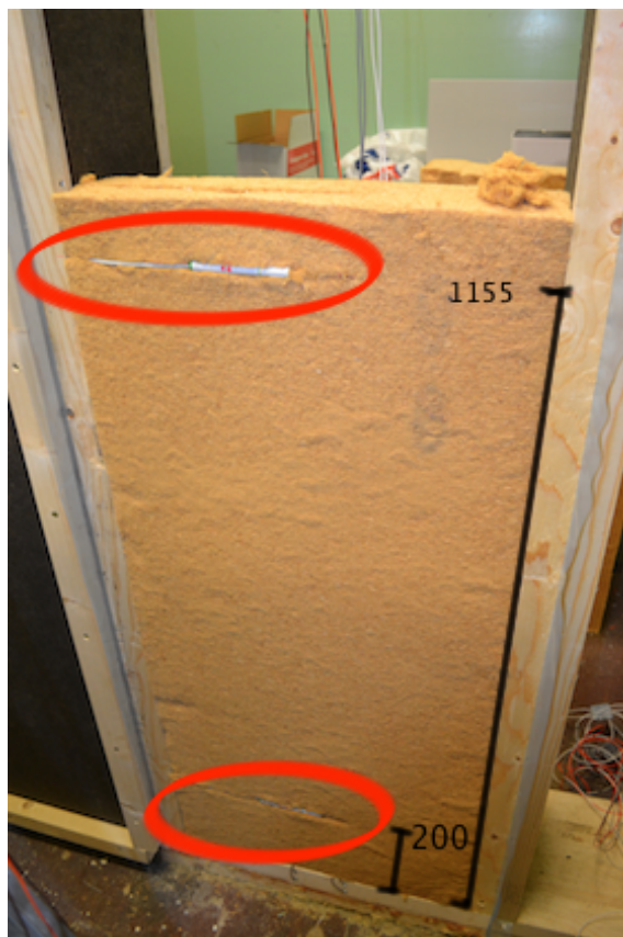
Figur 25: Montering av RF/T-sensorer i Flex
