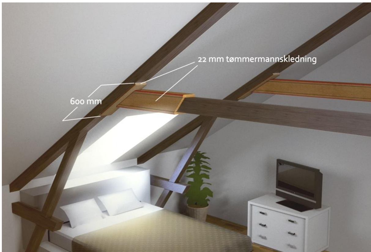
Figur 8.3 – Brannbeskyttelse av tverrsnitt
