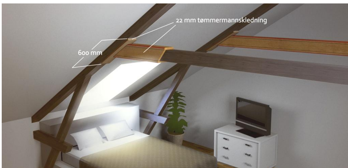
Figur 6.13 – Montering av 22mm panel på hovedbjelke (takstol 3 og 4) og hanebjelke (takstol 1-6) (panel på hanebjelke skal gå fra ende til ende, men er snittet opp i figuren for illustrering).
