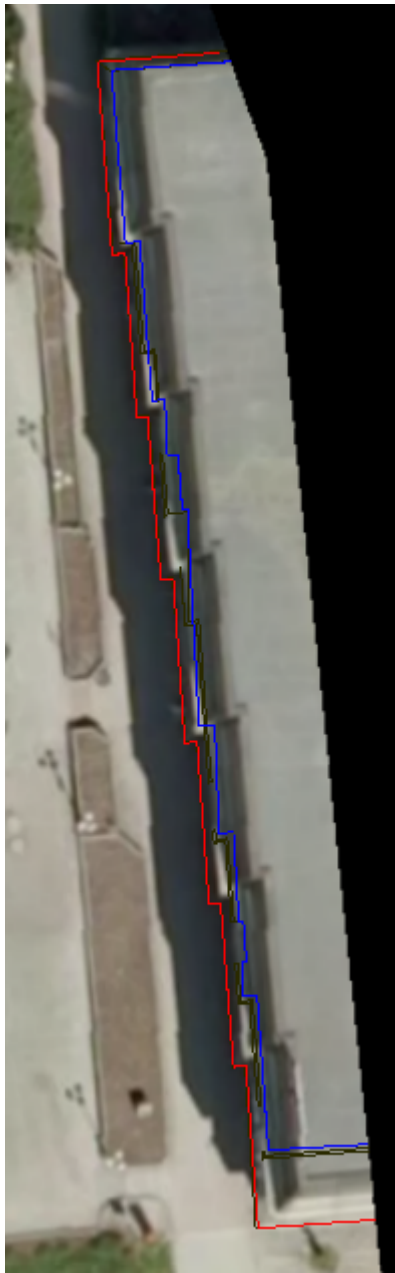
Figur 19: Fasadeliv: Bil i blått, Helikopter i rødt, landmålt i svart
