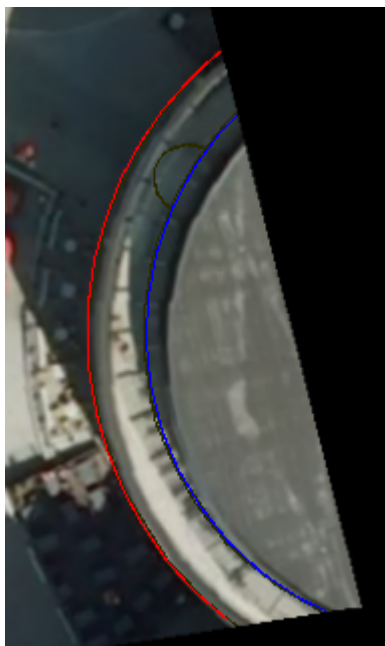
Figur 21: Fasadeliv: Bil i blått, Helikopter i rødt, landmålt i svart
