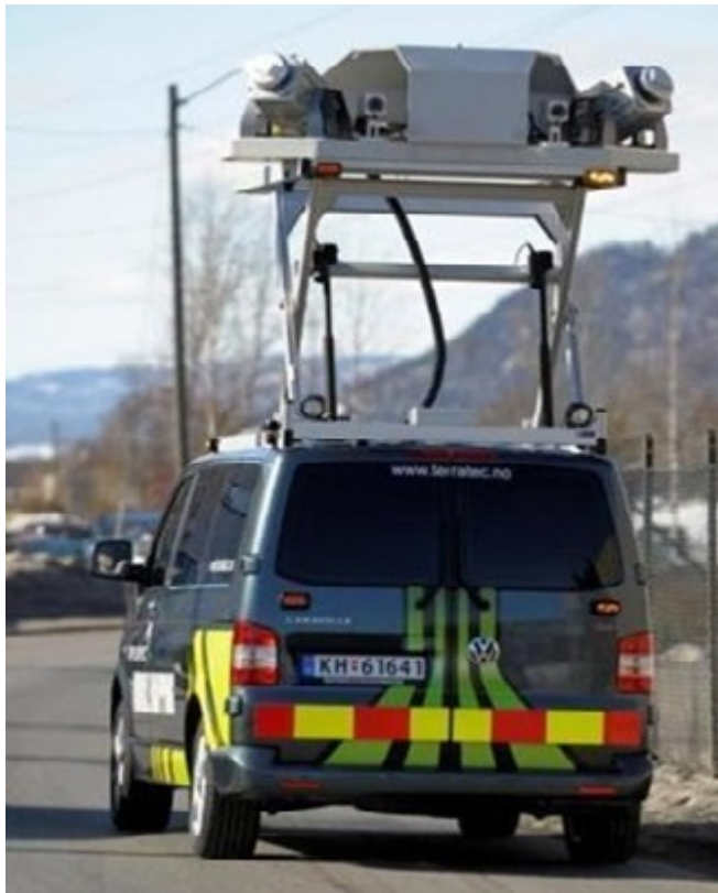
Figur 7: Bil med påmontert laser TerratecAS (2014)
