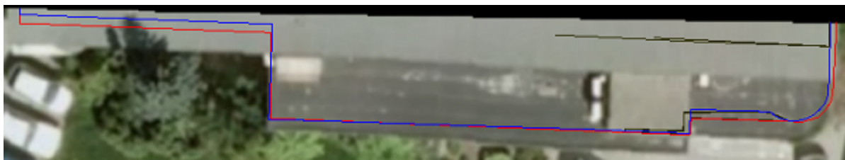
Figur 18: Fasadeliv: Bil i blått, Helikopter i rødt, landmålt i svart
