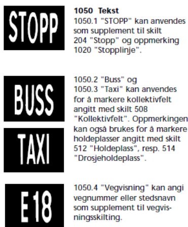
Figur 6.3: Eksempel på bruk av oppmerking 1050 «Tekst». Fra Statens Vegvesens håndbok 049 «Vegoppmerking».
