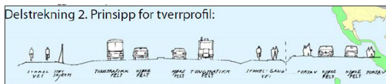
Figur 5.4: Prinsipp for tverrprofil for delstrekning 2 i Regionalplan for Transportkorridor vest. (Statens Vegvesen, 2013)
