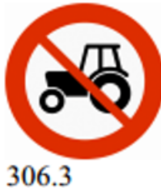
Figur 6.2: Forbudt for traktorer og for motorredskap konstruert for fart mindre enn 40 km/t. Fra Statens Vegvesens håndbok 050 «Trafikkskilt»
