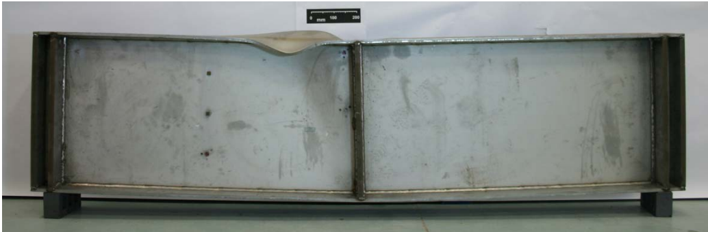
Figur 6 Typisk bruddform fremkalt av et dominerende bøyemoment [4]
