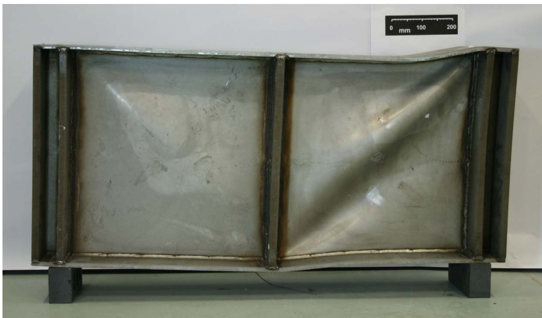
Figur 7 Typisk bruddform fremkalt av dominerende skjærkraft [4]
