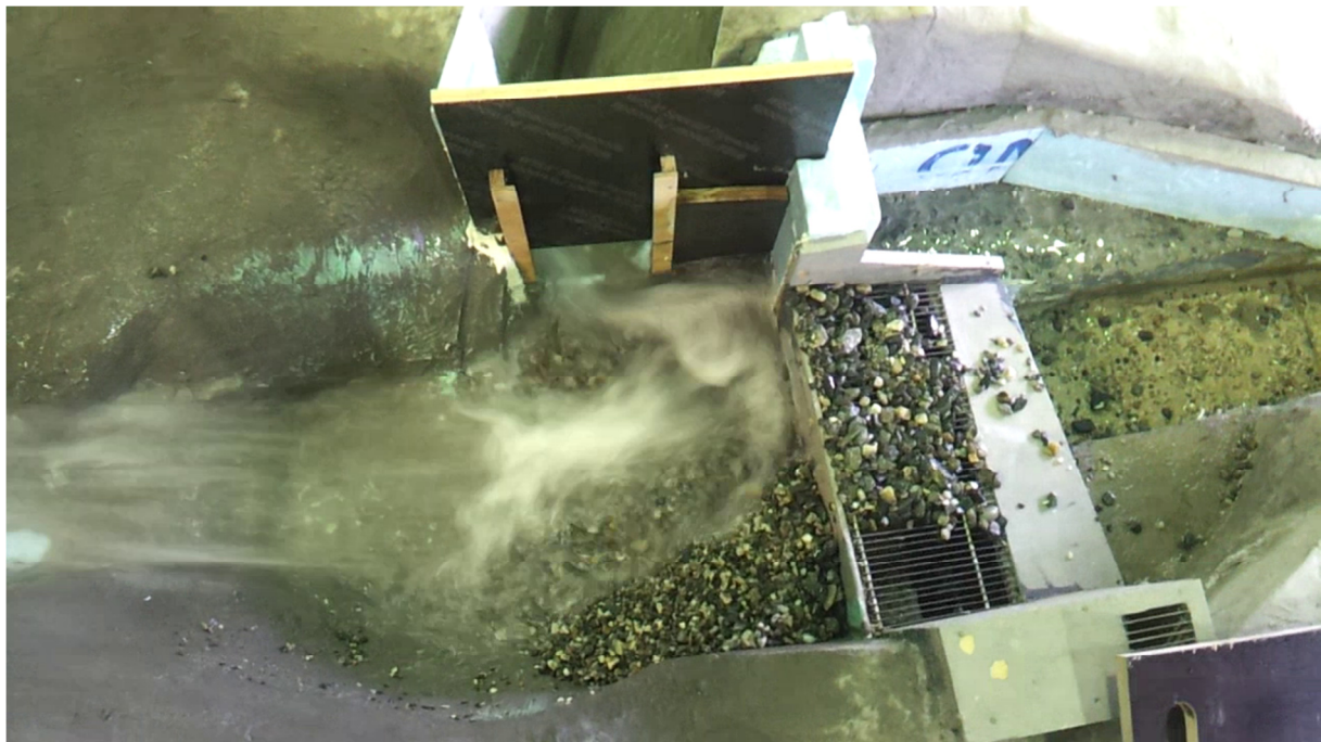
Figur 3.11: Sedimentforhold i inntaket ved slutten av spyling. 4 \text{ m}^3/\text{s} og 100% fyllingsgrad
