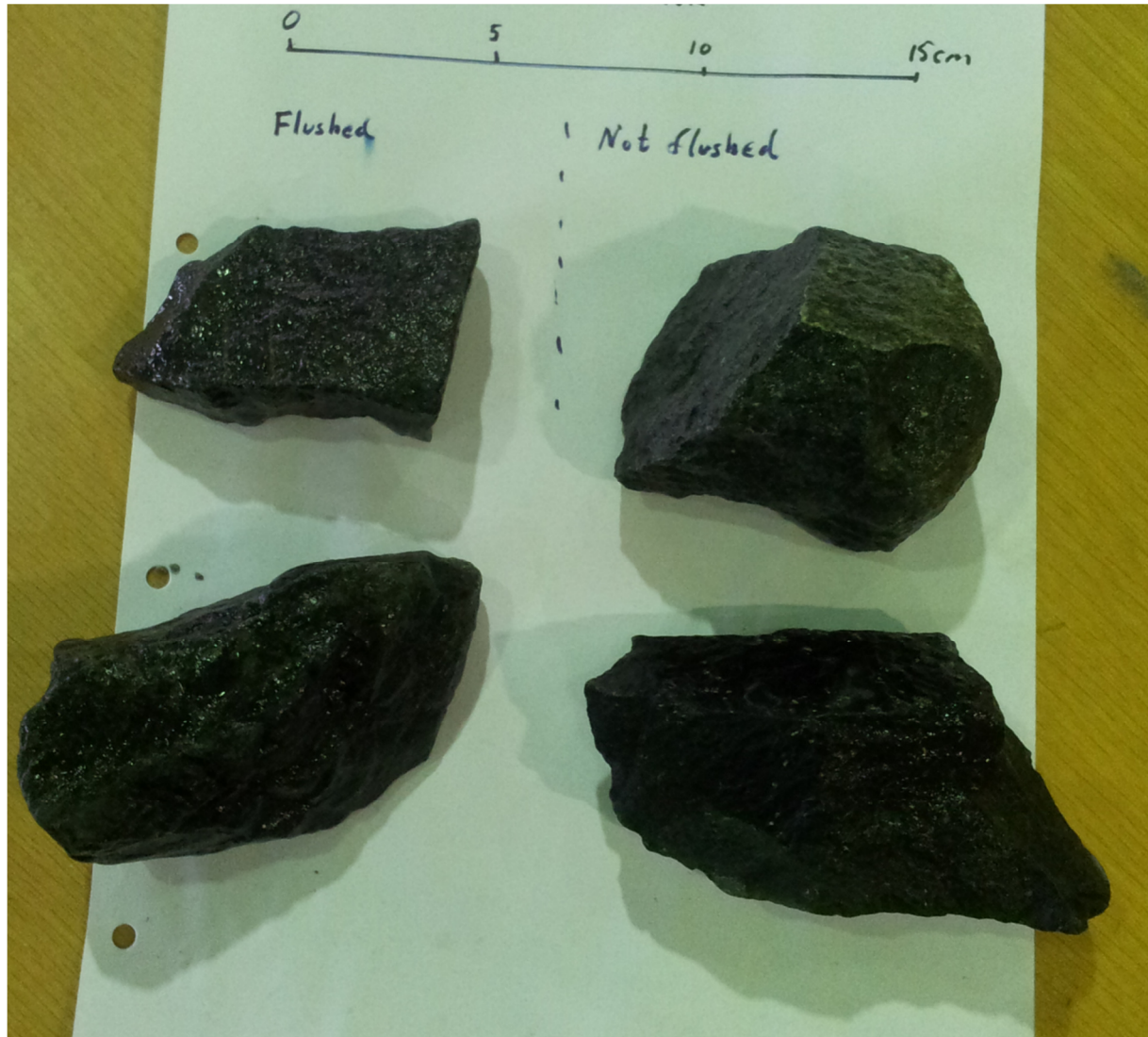
Figur 2.6: Blokker tilsatt sedimentene ved 4 \text{ m}^3/\text{s}
