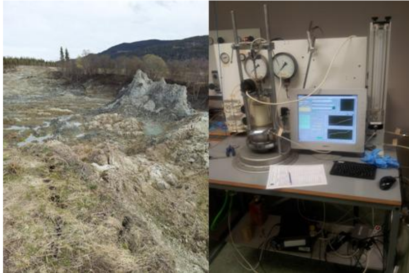
Figur 1-3: Skredkant bak etterskred og klargjøring av treaxsapparat.
