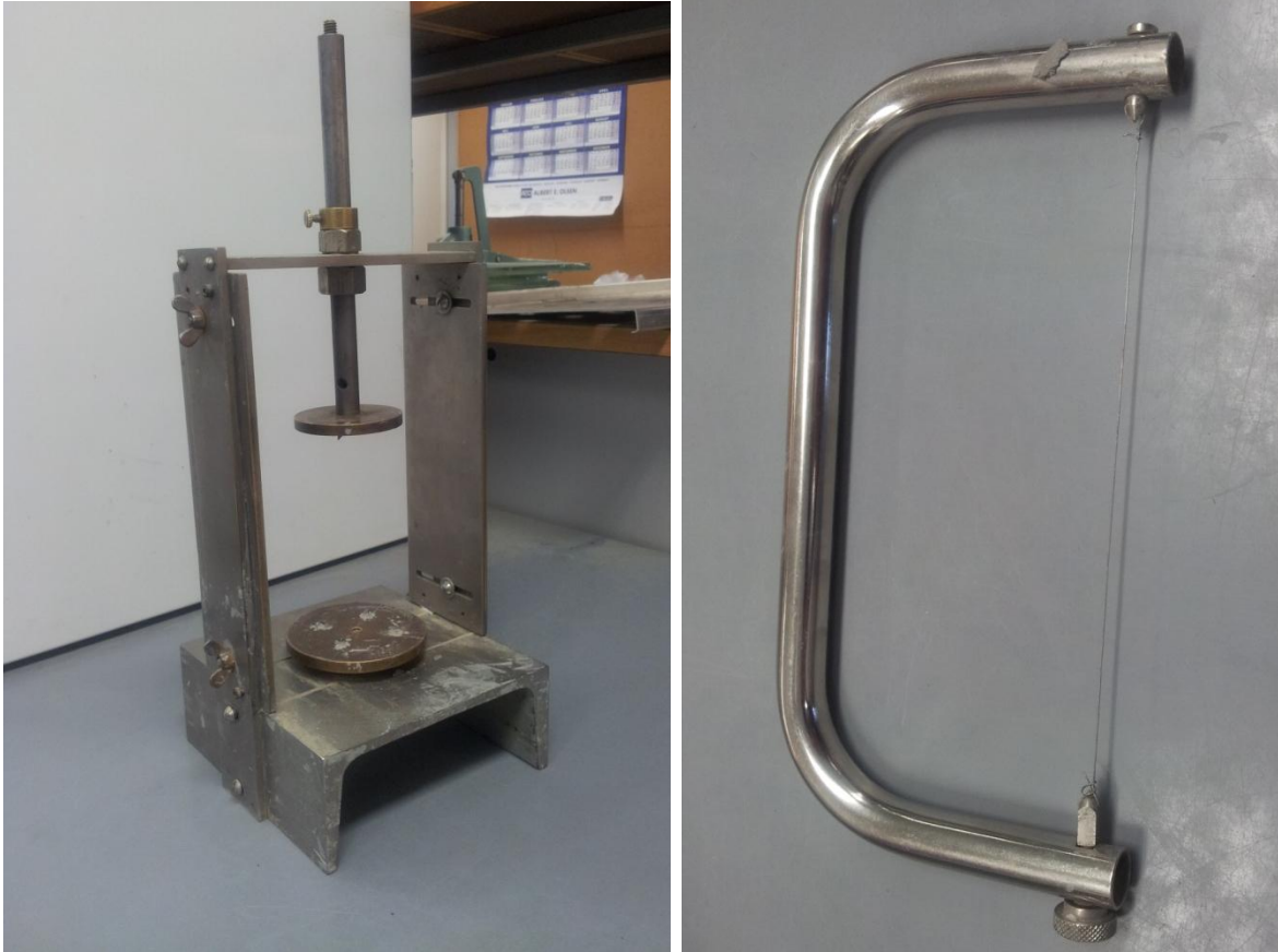
Figur 4-2: Stativ brukt for å trimme prøver til å ha et tverrsnitt på 54 mm diameter og en tråsåg som brukes til kuttingen.
