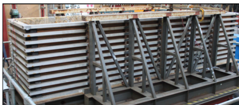
Figur 4.1: Boksen i ristebordforsøket (Scotto di Santolo et al. 2012).
